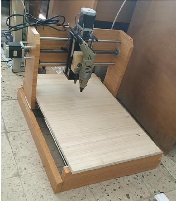
**Figure II.9 :assemblage des 3 axes(1) .**
