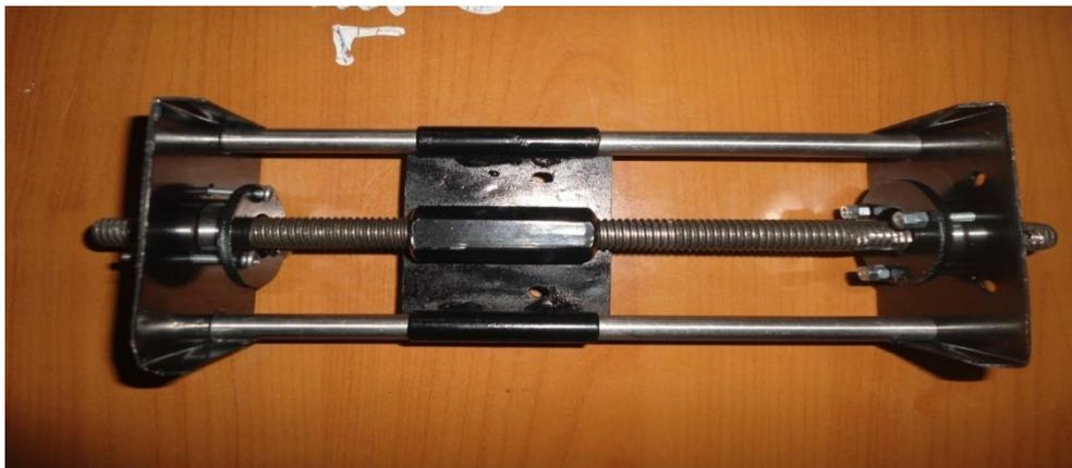
**Figure II . 7:Assemblage de l'axe Z(1) .**
