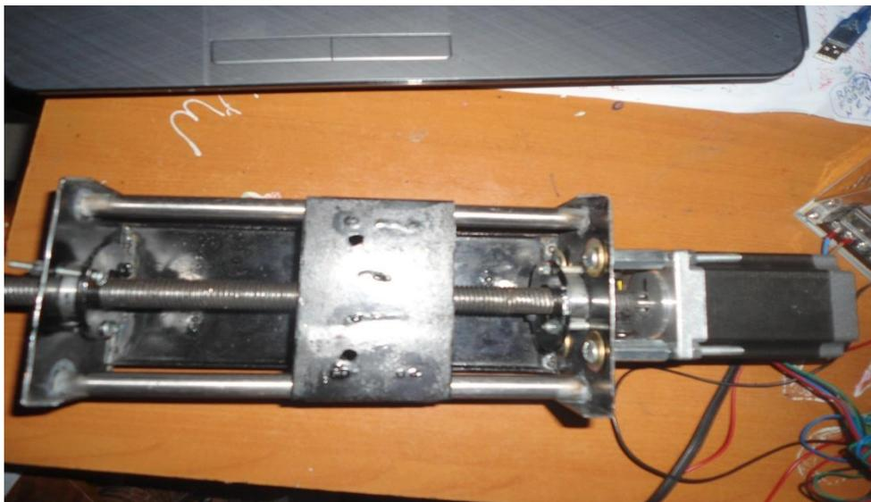
**Figure II.8 :Assemblage de l'axe Z(2).**
