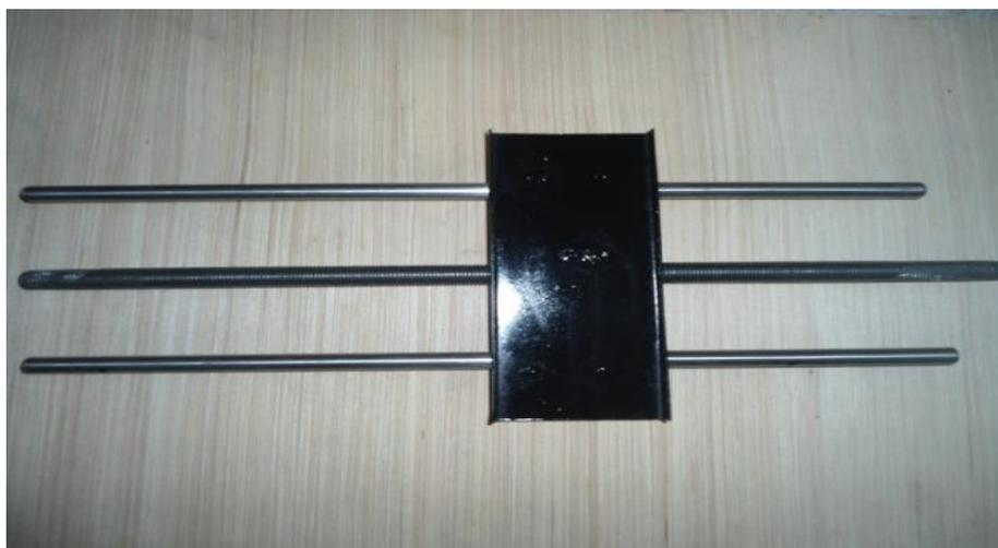
**Figure II.4 : Assemblage de La vis sans fin-écrouavec Axes de guidage**
