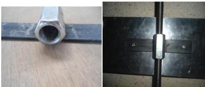
permet de transformer le mouvement de rotation en mouvement droit.
