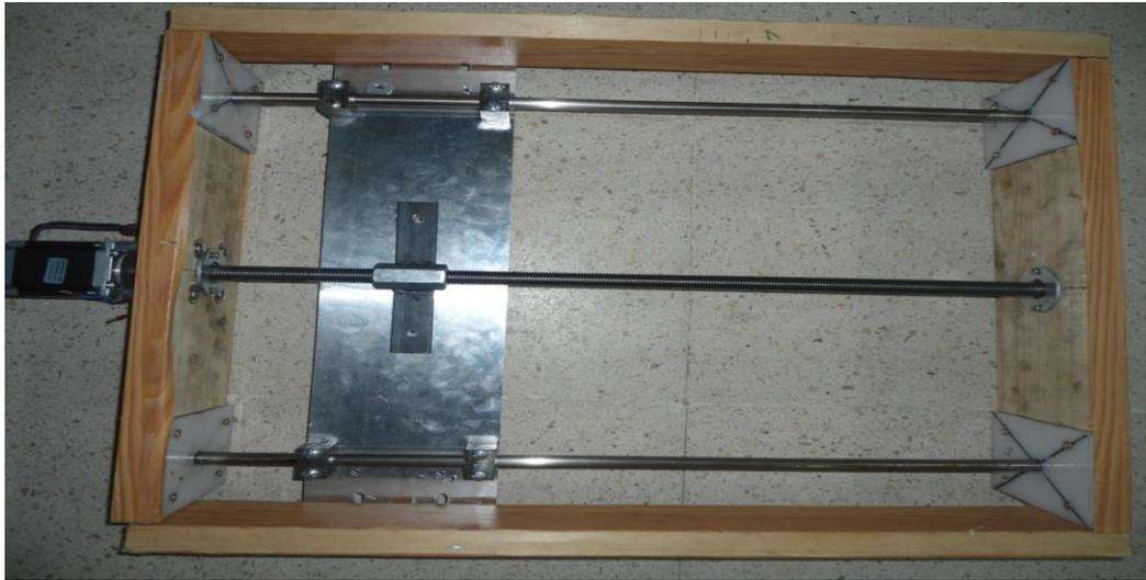
**Figure II.3 :Assemblage de l'axe x .**
