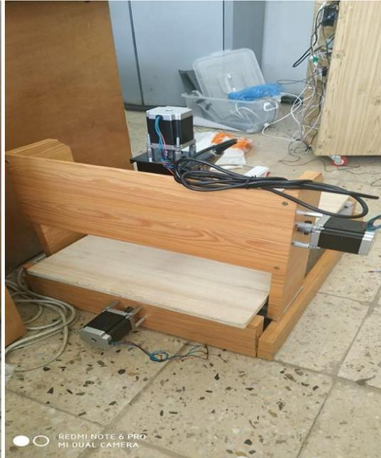
**Figure II.10 :assemblage des 3 axes(2) .**
