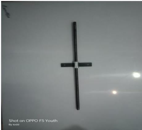
La vis sans fin-écrou est une tige filetée qui permet à l'aide d'unécrou de transformer la vitesse de rotation Du moteur en un mouvement de translation, et aussi elle assure des déplacements de grande précision, longueur de 65 cm.
