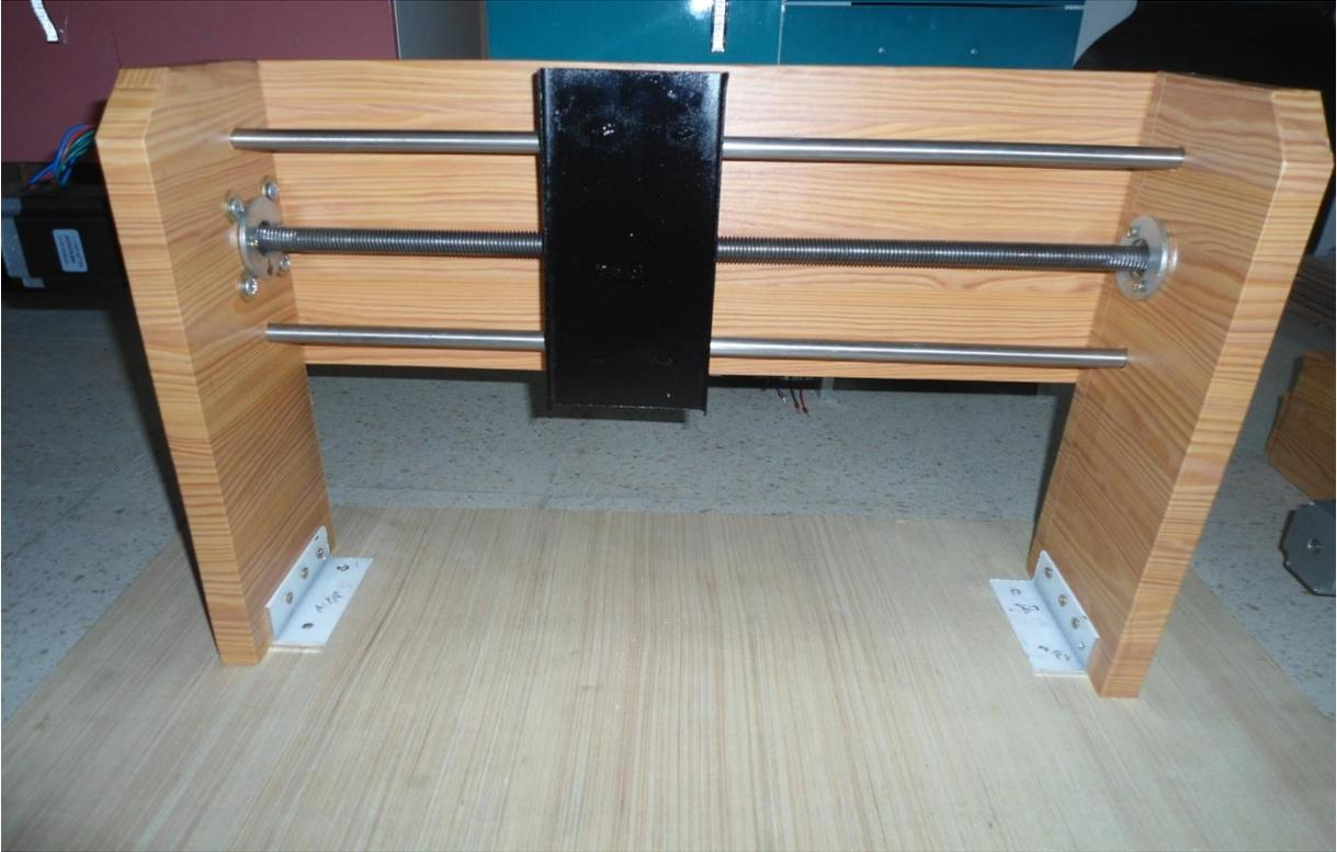
**Figure II.5 :Assemblage de l'axe de la face avant.**
