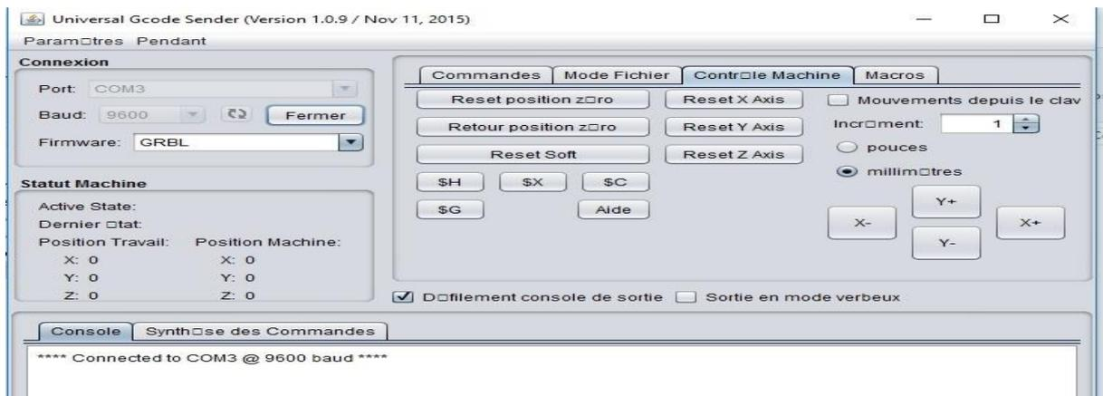
Figure V.12 : Initialiser les axes au point zéro manuellement sur logiciel G code
