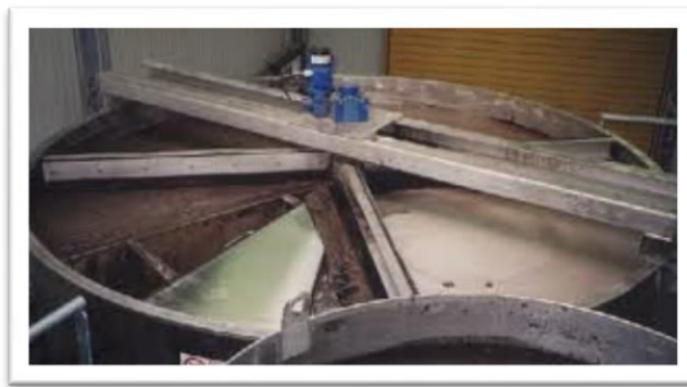
Figure 24 : Flottateur avec racleur en surface
