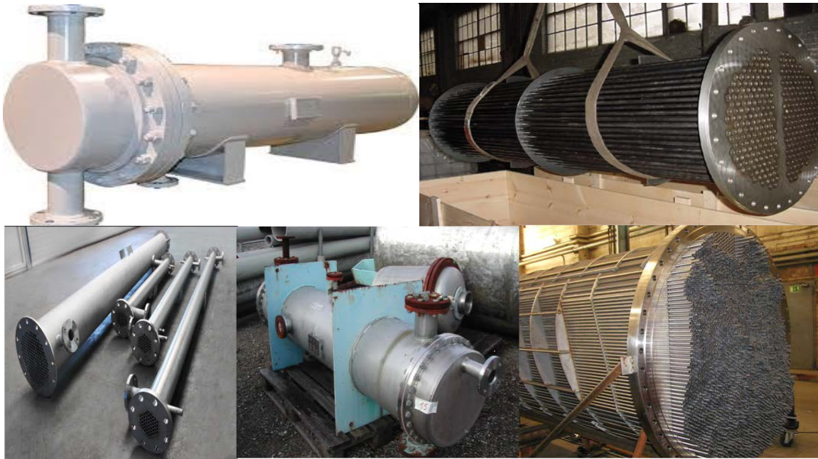
Figure IV.8: Vues diverses d'échangeurs de chaleur à faisceaux tubulaires et calandre
