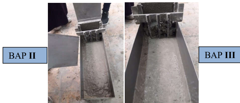
Figure III. 2: Essais de la boîte en L (BAP I, II et III).
