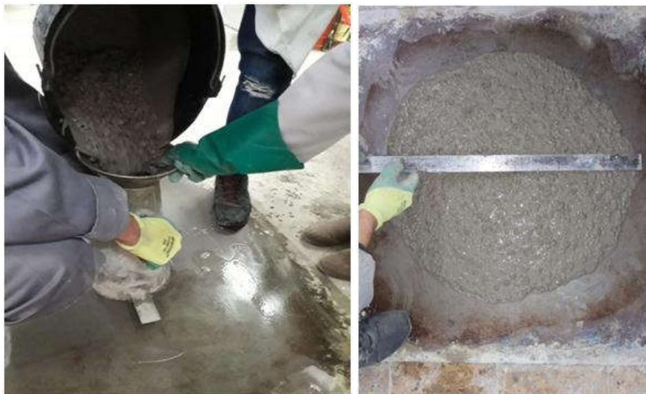
Figure II. 9: Essai d'étalement au cône d'Abrams exécutés au laboratoire.
