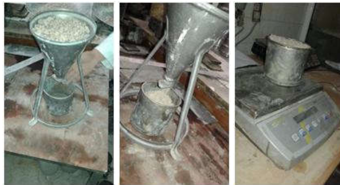
Figure II. 1: Essai de masse volumique apparente.
