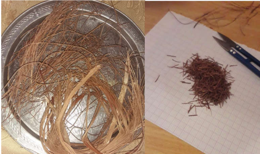
Figure II. 19 : Fibres découpées selon les longueurs désirées.
