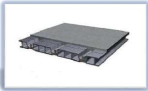
**Figure II-1 : Plancher à corps creux**
