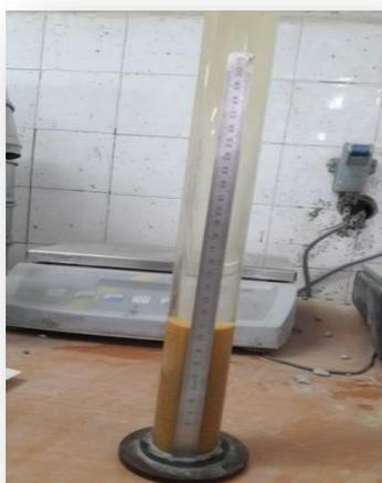
**Figure II.14.** Equivalent de sable
