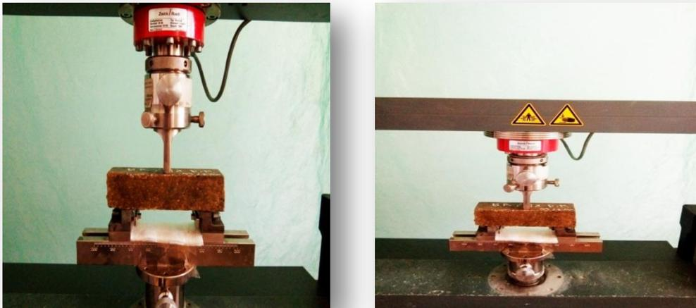
*Figure III.4. Dispositif de flexion 3 points.*
