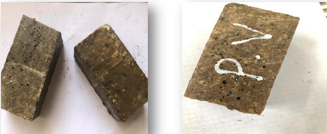
*Figure III.16. Mode de rupture des éprouvettes en compression.*
