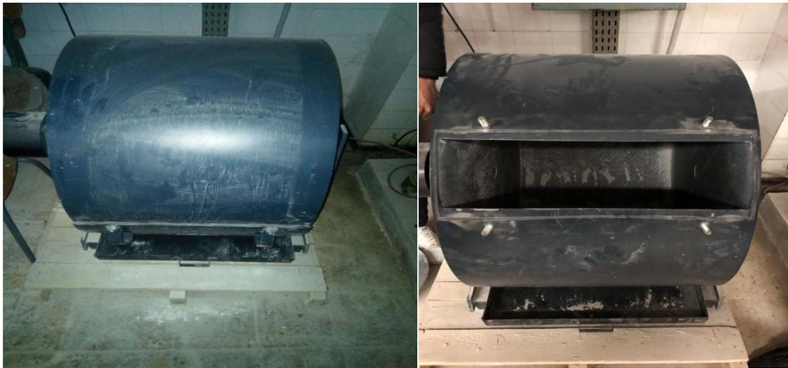
*Figure II.15. Essai Los Anglos.*
