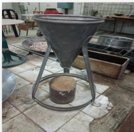
*Figure II.9. Masse volumique apparente du sable de dune.*
