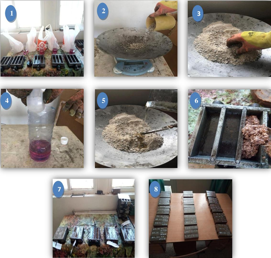
Figure II.18. Processus de la fabrication des micro-bétons résineux.
