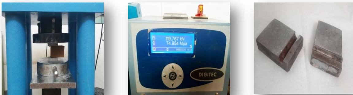
*Figure III.5. Dispositif de compression.*
