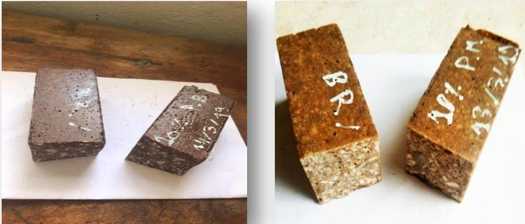
*Figure III.15. Mode de rupture des éprouvettes en flexion.*
