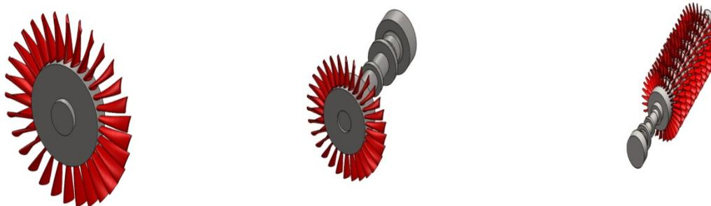
Figure VI.2 : assemblage du rotor
