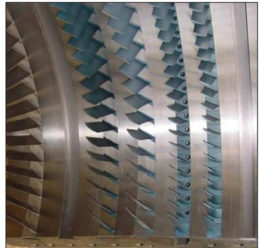
***Figure II.7: Aubes du stator du compresseur***
