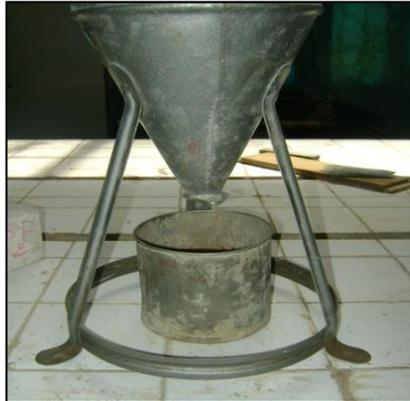
**Figure II.10.** Appareillage de la masse volumique apparente
