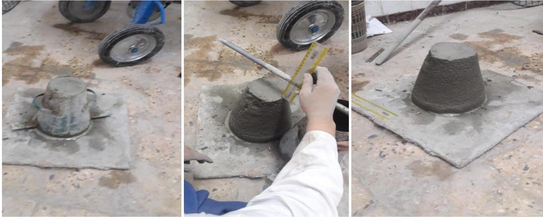
Figure III.2. Essai d'affaissement cône d'Abrams
