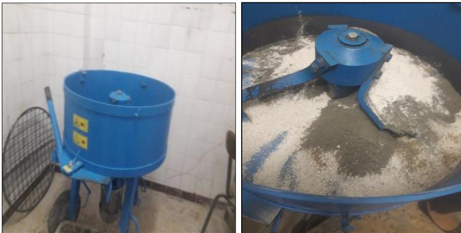
**Figure IV.1.** Malaxeur pour béton
