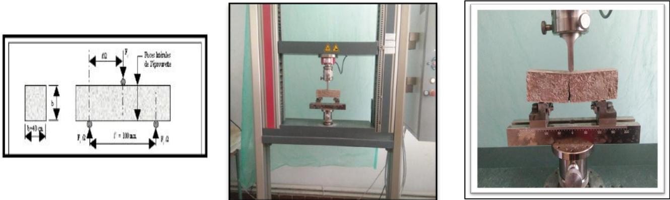
Figure IV.5. Essai de traction par flexion
