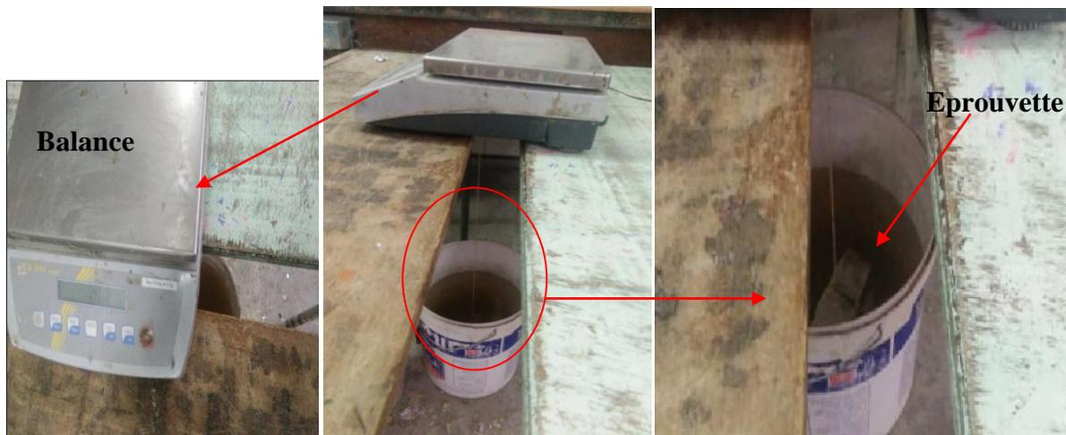
**Figure IV.6.** Mesure de la porosité accessible à l'eau / Pesée hydrostatique
