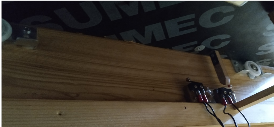
Figure III.19 Mécanisme de retournement utilisant les limites switch
