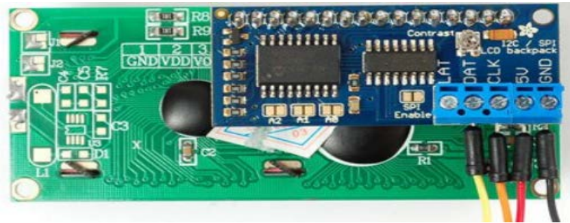
Figure III.4 Afficheur LCD à base du protocole I2C
