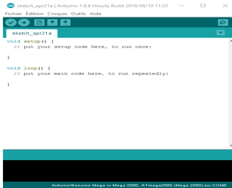
Figure III.7. Interface d'utilisation du logiciel Arduino
