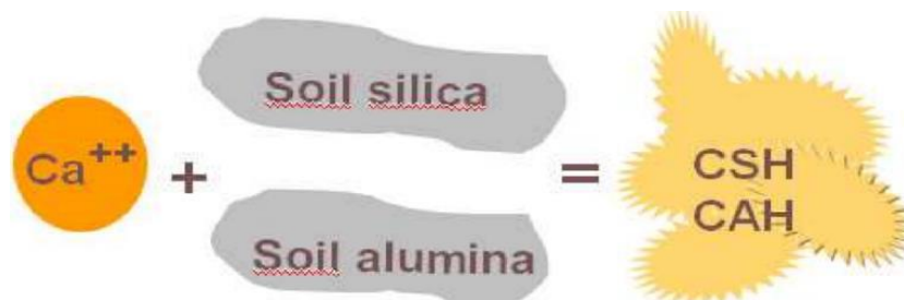
Figure 1.4 Réaction pouzzolanique (Marrot, 2010).
