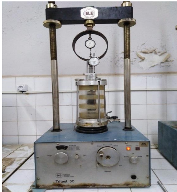
Figure 2.18 Préparation de la machine TRIAXIAL Universelle.
