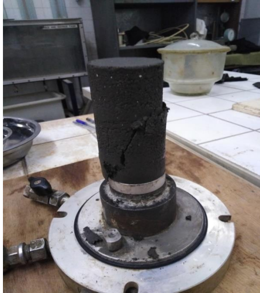
Figure 2.20 Echantillon de sol poinçonné.
