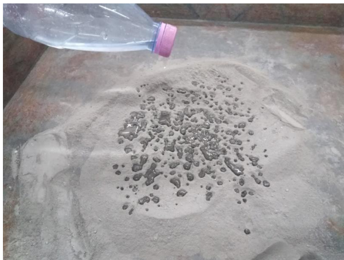
Figure 2.14 Ajout de la proportion d'eau au mélange de DD3 plus bentonite et laitier pour atteindre une teneur en eau prédéterminée.
