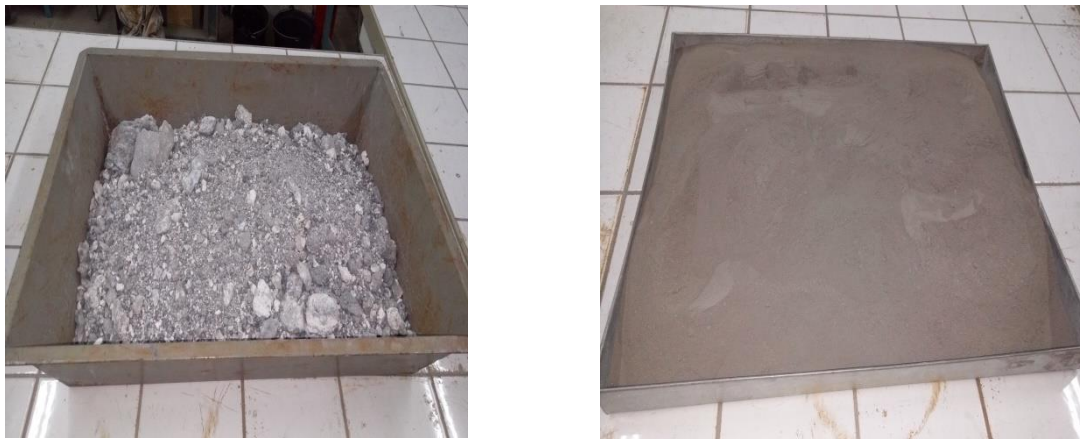
Figure 2.2 Kaolinite DD3 granulé et broyé.
