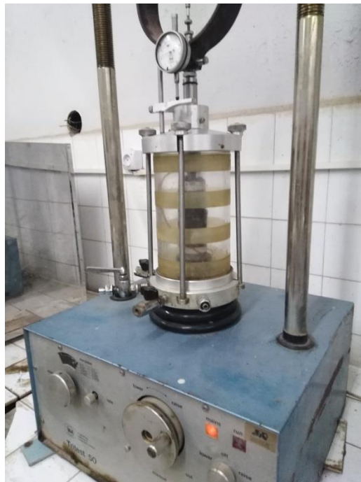
Figure 2.19 Poinçonnement de l'éprouvette de sol.
