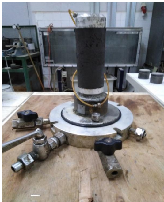
Figure 2.17 Echantillon de sol décoffré placé entre les deux embases.
