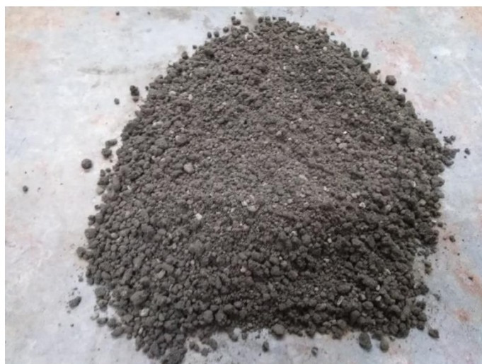
Figure 2.15 Sol humide mélangé avec du GGBFS.
