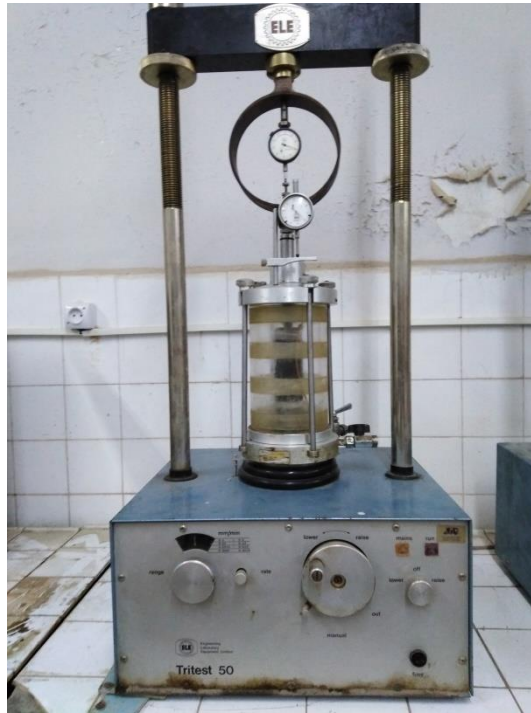
Figure 1.1 Machine universelle de l'essai triaxial Université Badji Mokhtar-Annaba.
