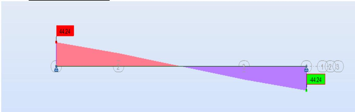
Figure 44 : Diagramme des efforts tranchant niveau courant et à ELU
