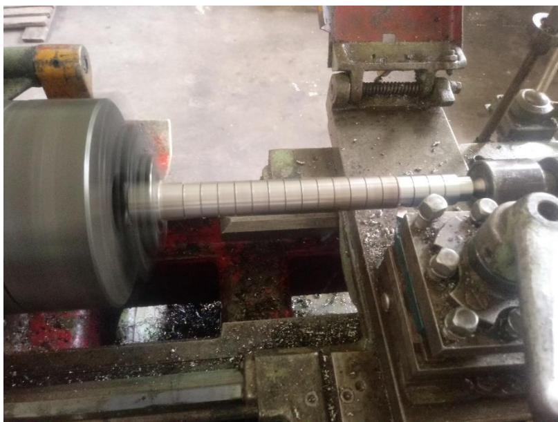
Figure III.4 : Usinage de l'éprouvette
