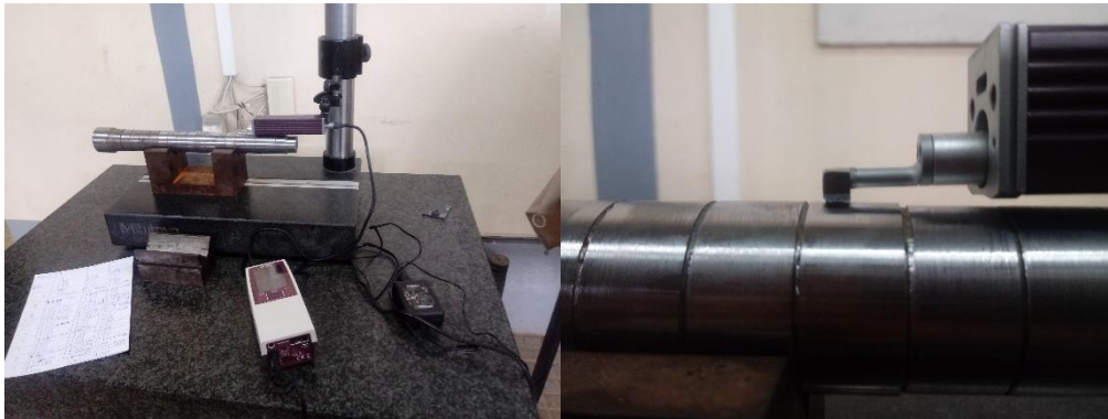
Figure III.6 : Mesure de la rugosité
