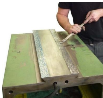
Figure I.6 : Opération de grattage manuel des glissières
