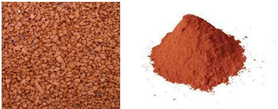
Figure I. 13 .Granulats de brique Figure I. poudre de brique
