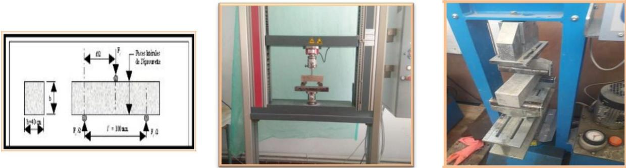
Figure IV.3. Essai de traction par flexion
