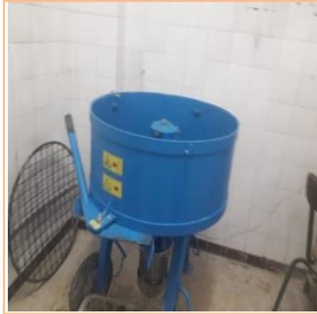
**Figure IV.1.**Malaxeur pour béton
