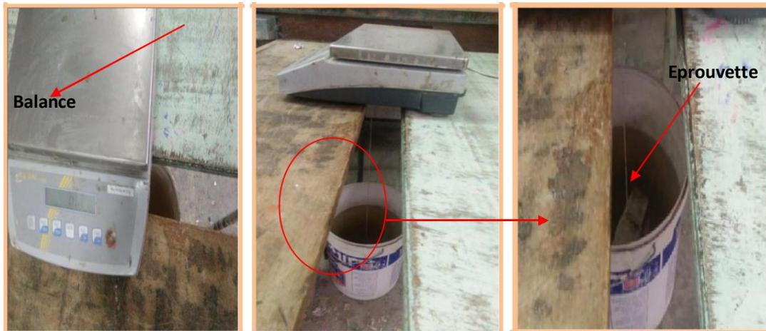
**Figure IV.4.** Mesure de la porosité accessible à l'eau / Pesée hydrostatique
