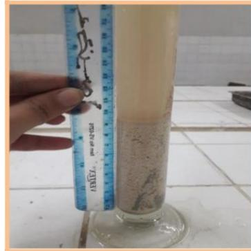
Figure II.7. Equivalent de sable
