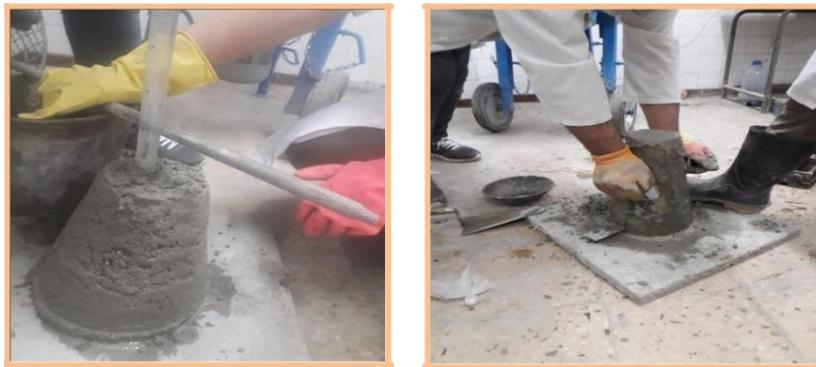
Figure III.2. Essai d'affaissement cône d'Abrams
