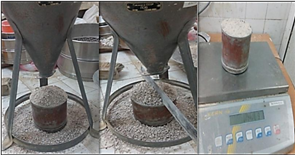
Figure II.7 : Essai de masse volumique apparente.
