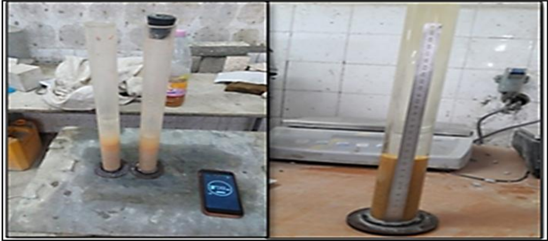
Figure II.6 : Essai d'équivalent de sable.
