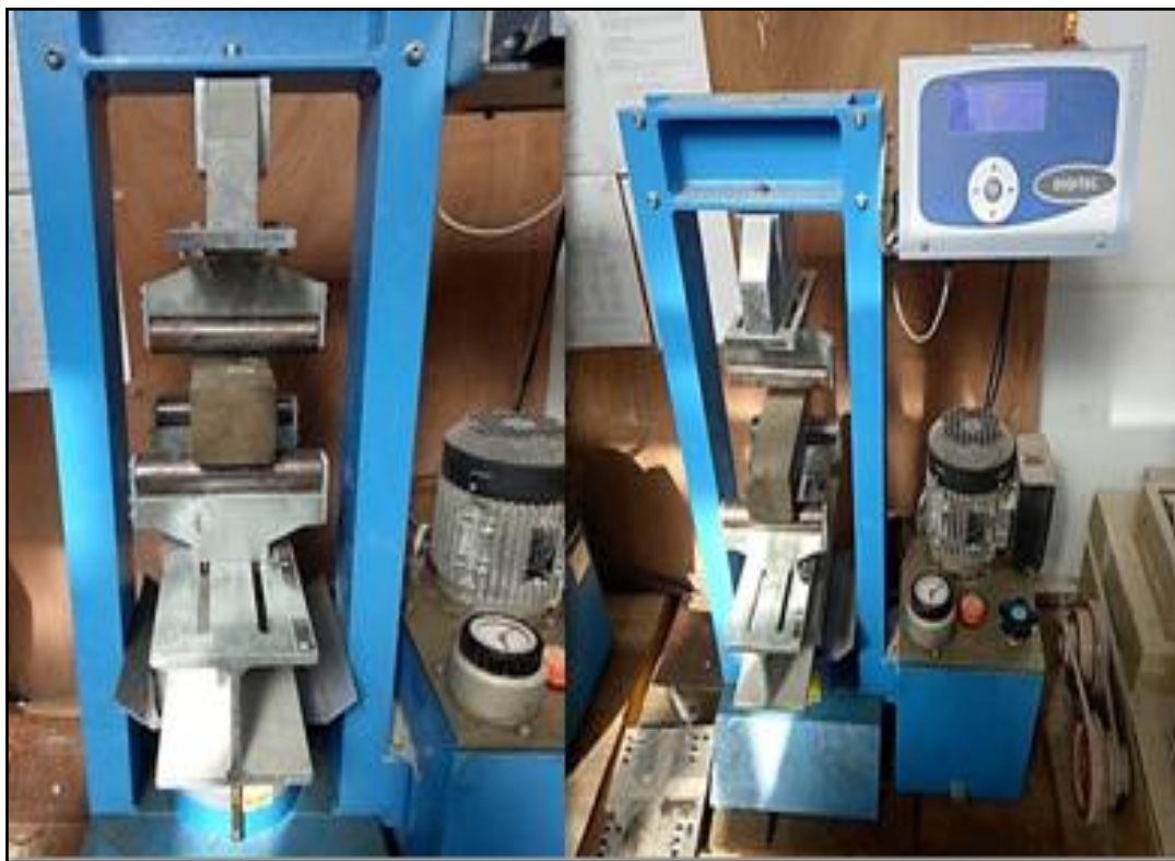
Figure III.11 : Dispositif d'essai de traction par flexion.
