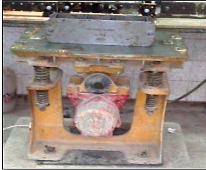
Figure III.3: Eprouvette sur la table vibrante.
