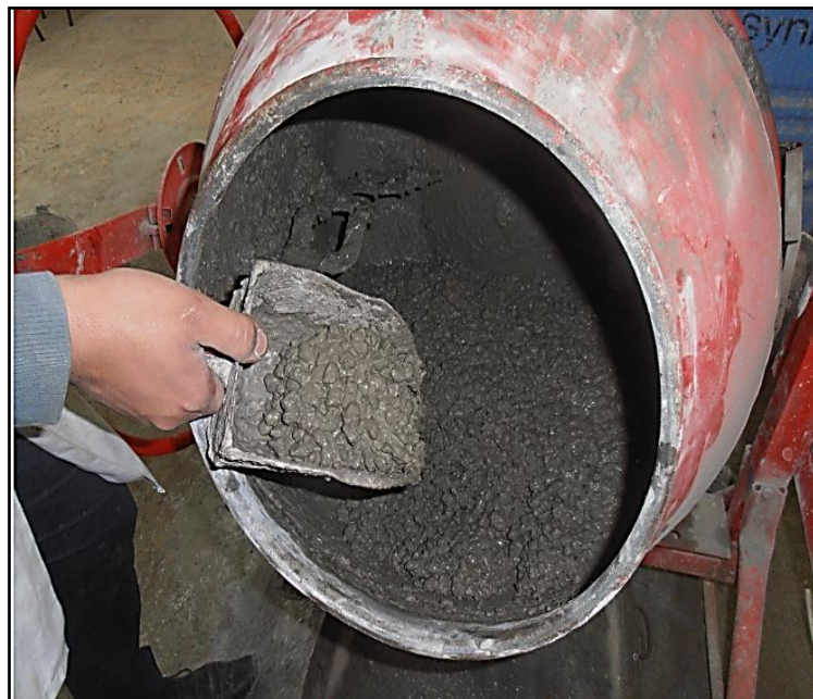
Figure III.2 : Bétonnière utilisée pour le malaxage des composants.
