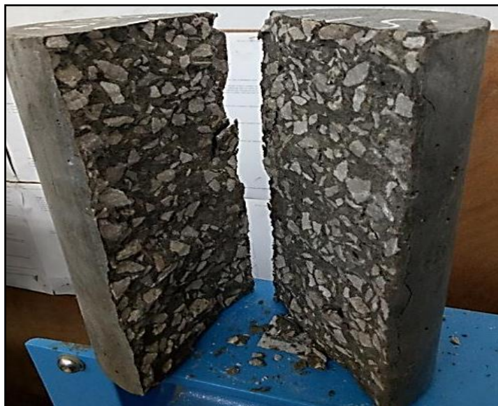
Figure III.18 : Modes de rupture des éprouvettes soumises à la traction par fendage.
