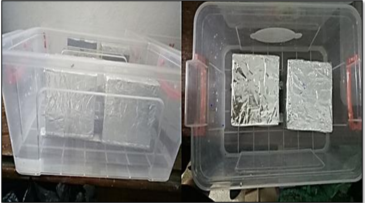
Figure III.28 : Essai de l'absorption d'eau par capillarité.
