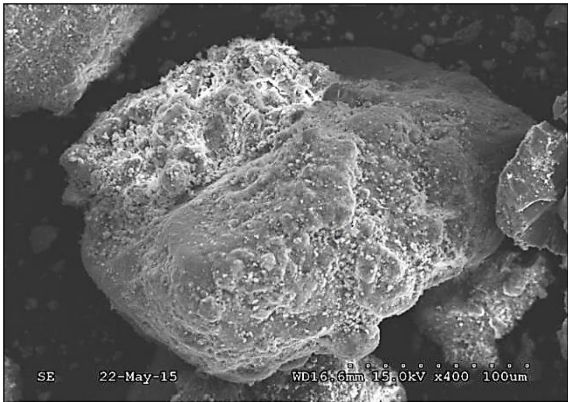
Figure III.22 : Morphologie et état de surface de sable recyclé [32].
