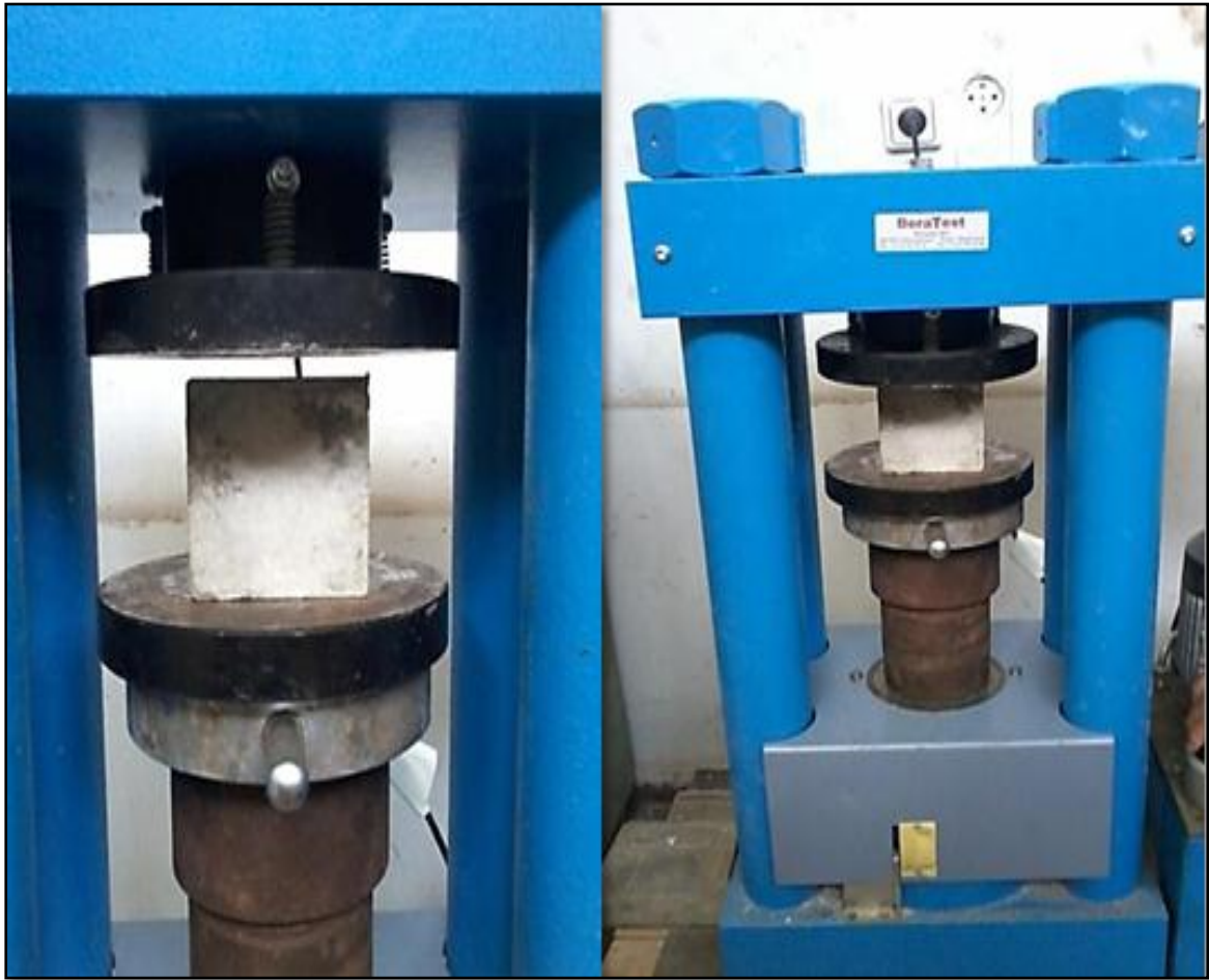
Figure III.7 : Machine de compression utilisée.
