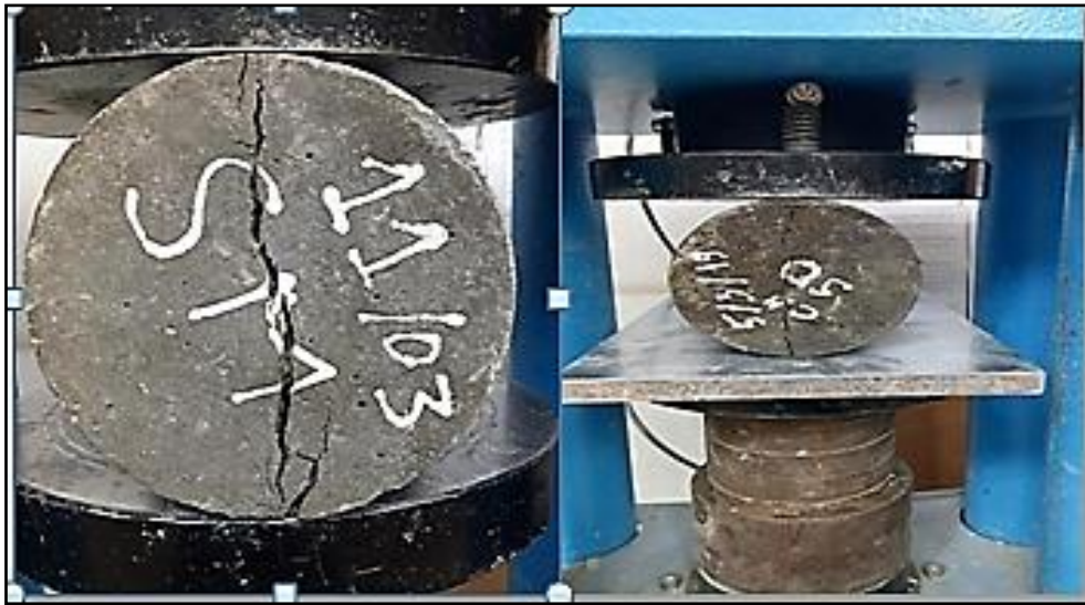
Figure III.17 : Dispositif d'essais de traction par fendage.
