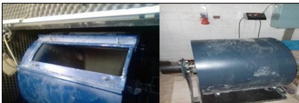
Figure II.10 : La machine de Los Angeles.
