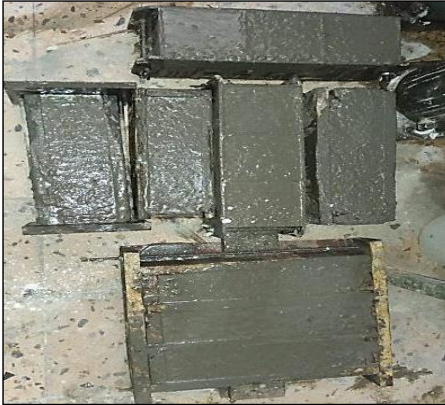
Figure III.4 : Remplissage des différents moules.
