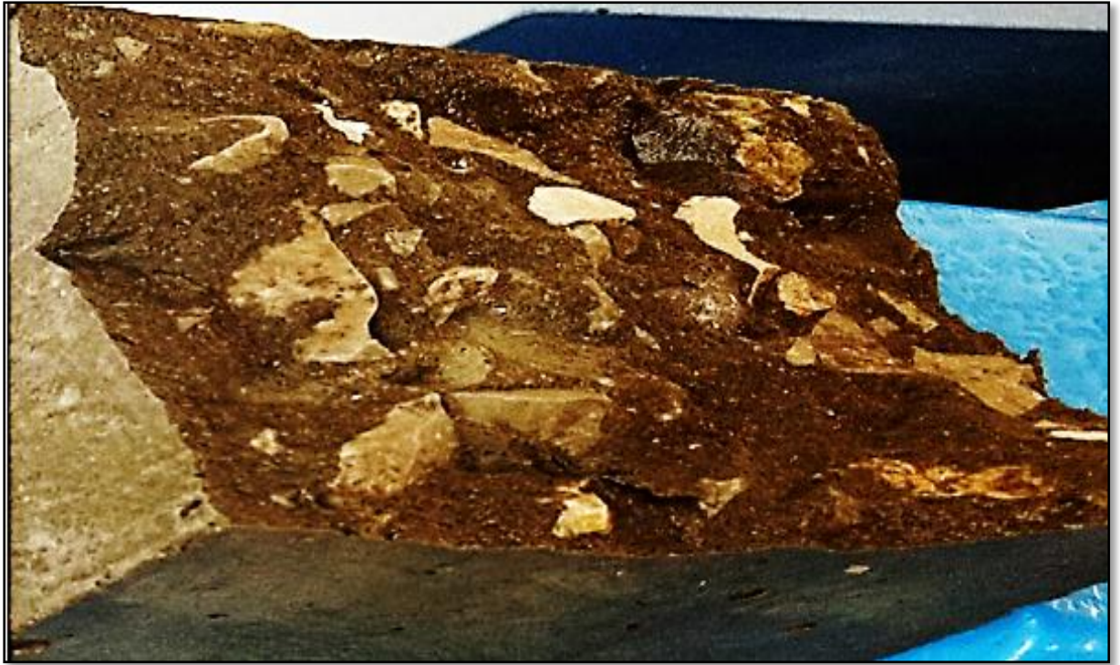
Figure III.15 : Rupture fragile par clivage (transgranulaire).
