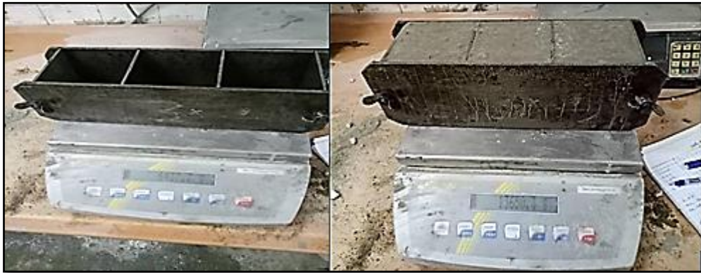
Figure III.6 : Essai de la masse volumique a l'état frais.
