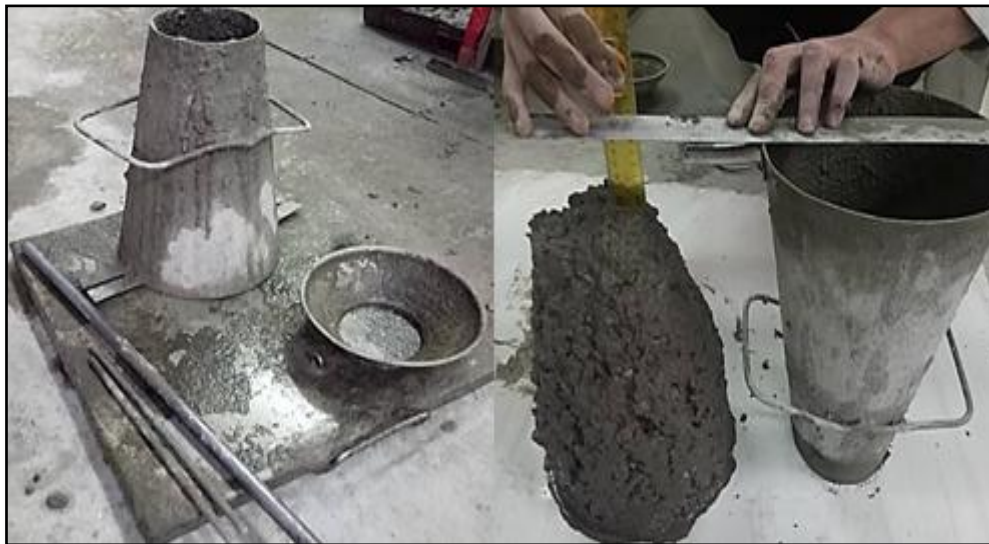
Figure III.5 : Essai d'affaissement au cône d'Abrams.
