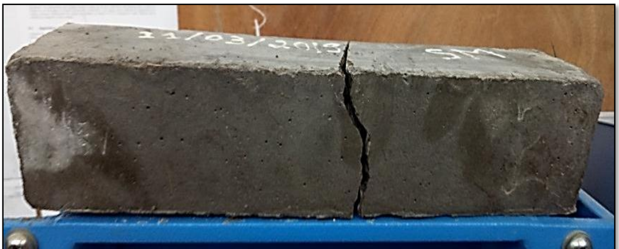
Figure III.14 : Rupture inclinée à gauche.
