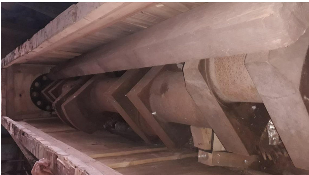
Figure.III.1 : Vue réelle d'un ancien vilebrequin.
