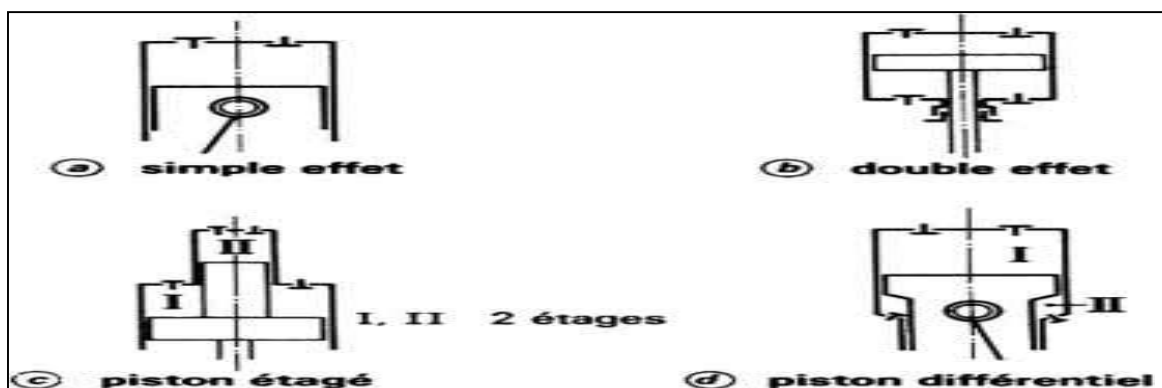
Figure II.10 : Différents modes de travail du piston
