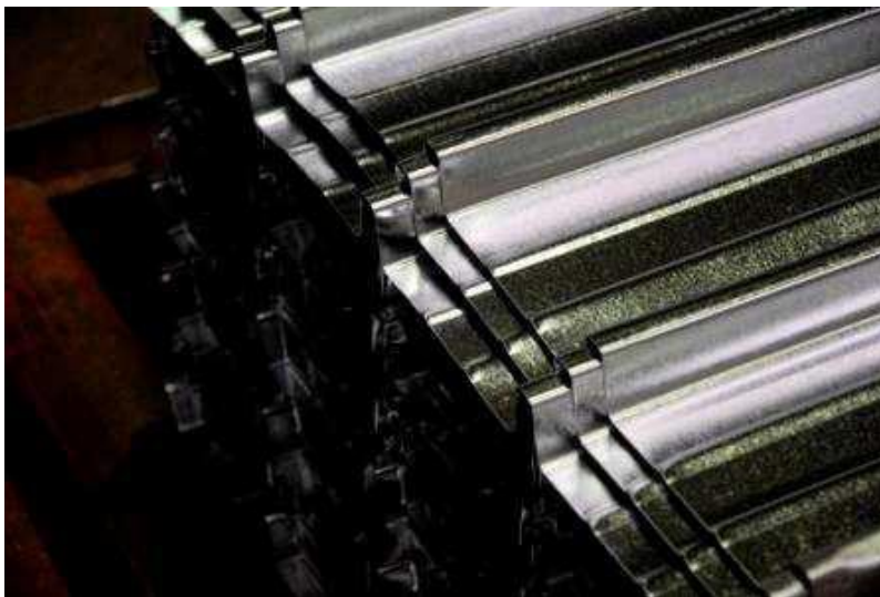
Figure I.8: Galvanisation à Chaud (RPA)
