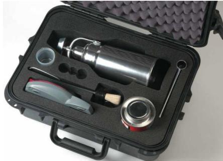
**Figure 29** : : appareil speedy
