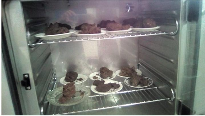
**Figure 33** : l'échantillons de sol humide dans l'Etuve
