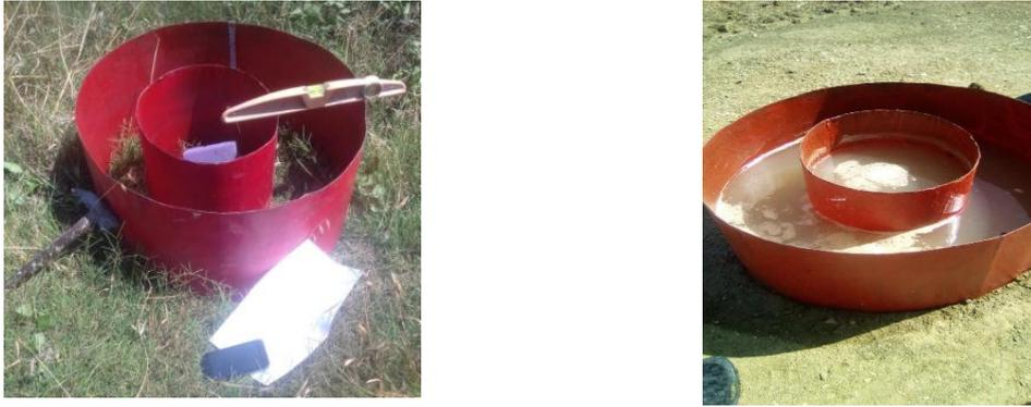
**Figure 24** : Etapes et matériels utilisés pour l'implémentation de l'infiltromètre double anneaux
