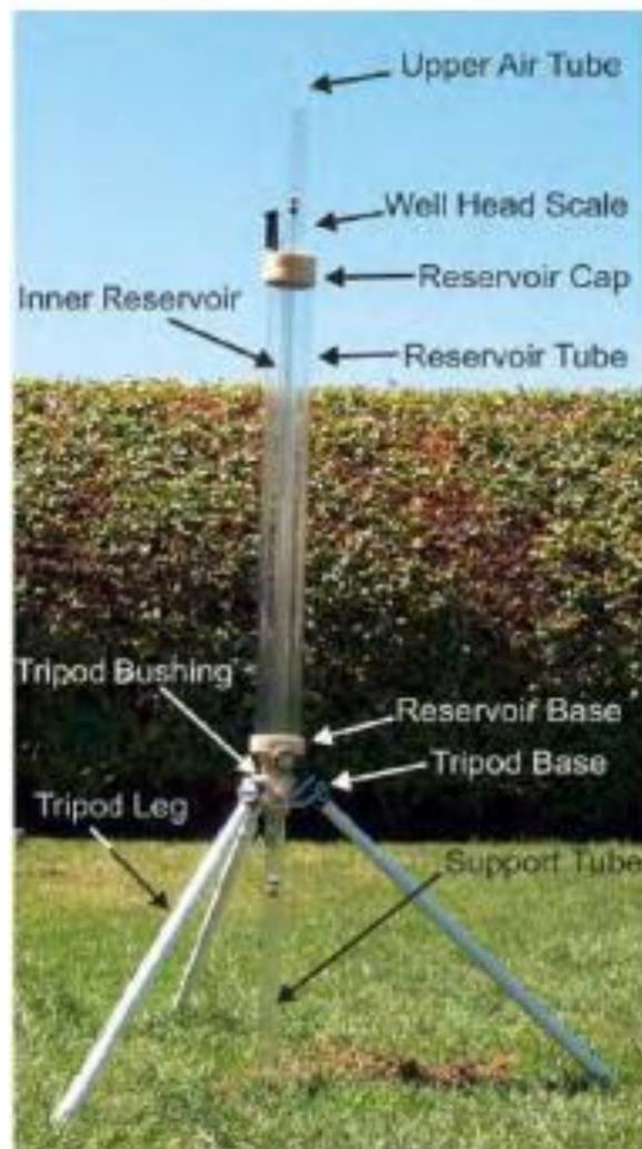
**Figure 1** ; Composantes du perméamètre de Guelph (Eijkelkamp Agrisearch Equipment (EAE), 2011)
