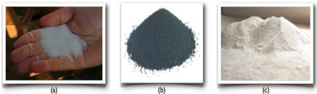
**Figure : I.8** Exemples de charges utilisées dans les CMO : (a) micro-billes de verre, (b) noir de carbone, (c) silice.
