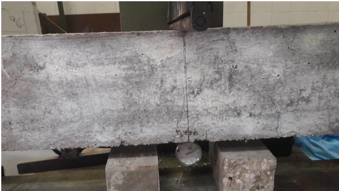
Figure III 32 Mode de fissuration de la poutre en béton fibré et ferrillé. (Apparitions de la fissure)
