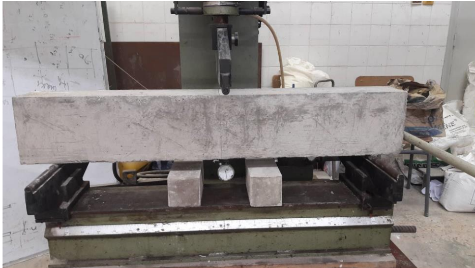
Figure. III 22. Essai de Flexion sur la poutre en béton fibré
