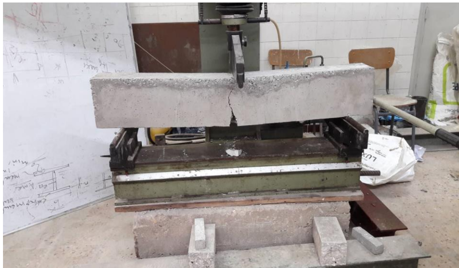
figure III 10. Mode de fissuration et de rupture de La poutre en béton témoin
