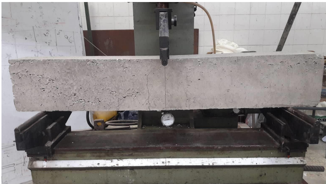
Figure. III 14 Mode de fissuration de La poutre en béton Armé
