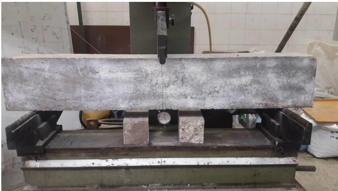
Figure III 31 Essai de flexion sur la poutre en béton fibré et ferrailé.
