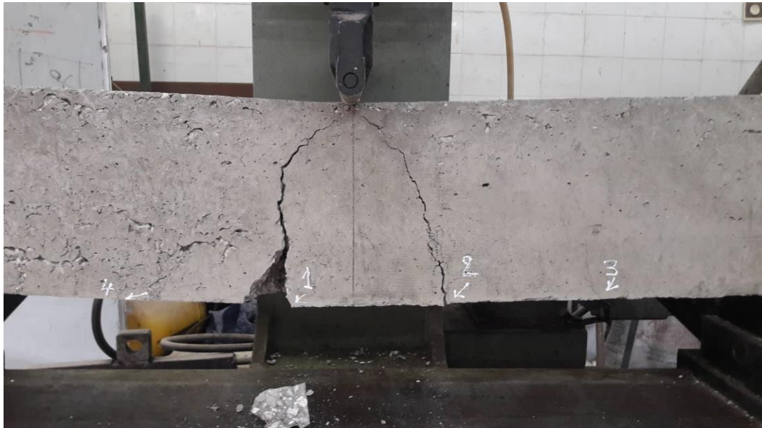
Figure III 16 les fissures sur la poutre en béton armé
