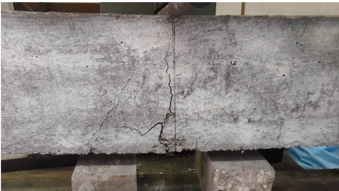
Figure III 33 Mode de fissuration de la poutre en béton fibré et ferrillé (développement de la fissure)
