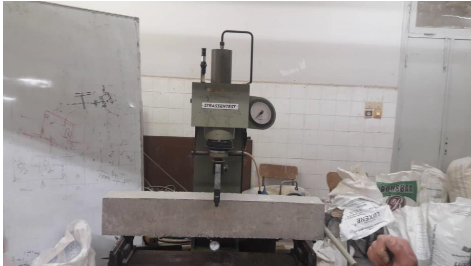
Figure III 9. Essai de flexion de la poutre en béton témoin
