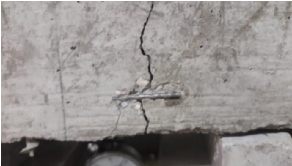
Figure III 24 Mode de fissuration de la poutre en béton fibré (développement de la fissure)
