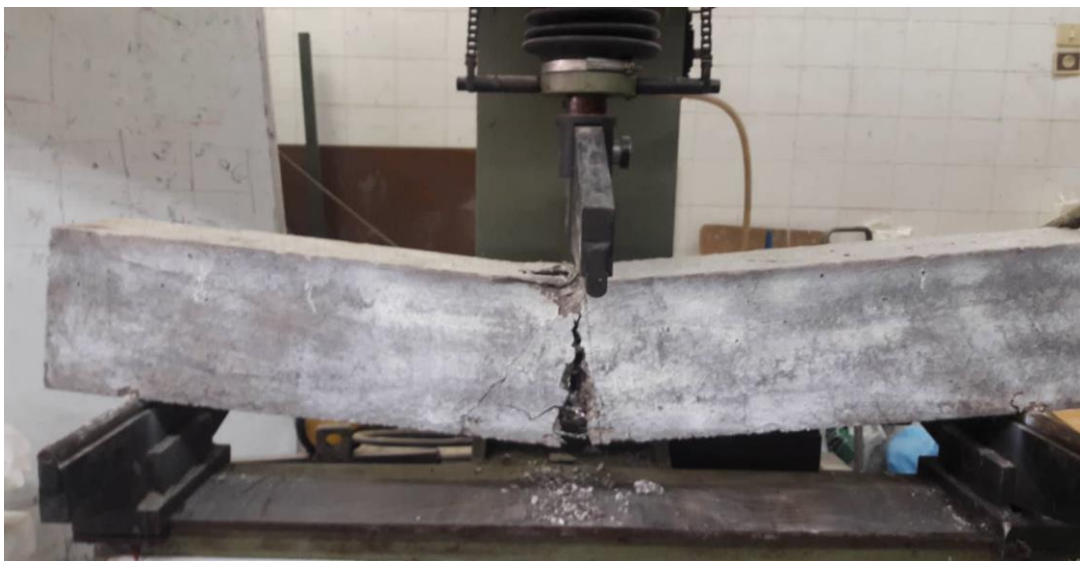
Figure III 35 mode de rupture de la poutre béton fibré et ferrillé (phase de rupture)
