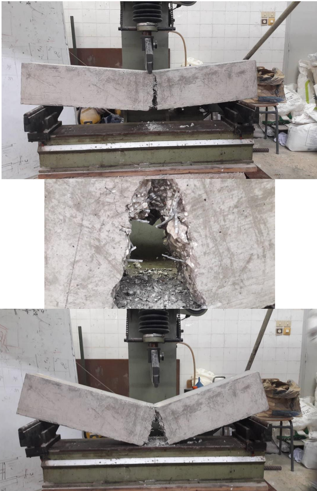
Figure. III 25 mode de rupture sur la poutre en béton fibré (phase de rupture)
