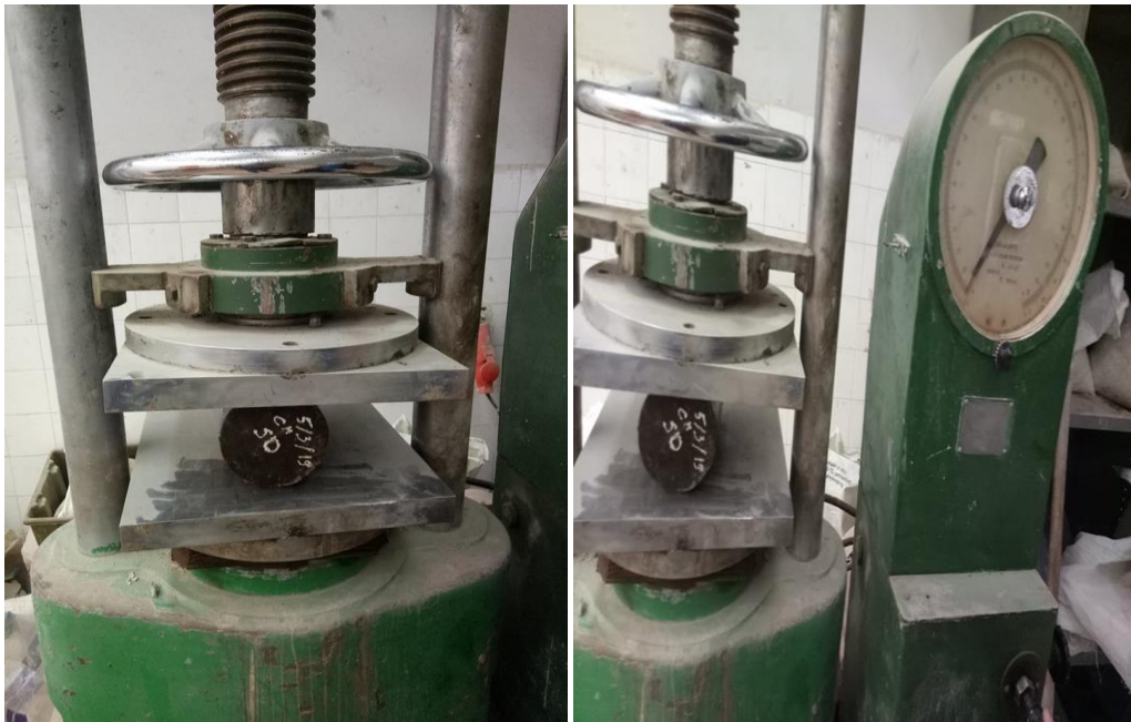
Figure II-21. Appareil de la traction par fendage
