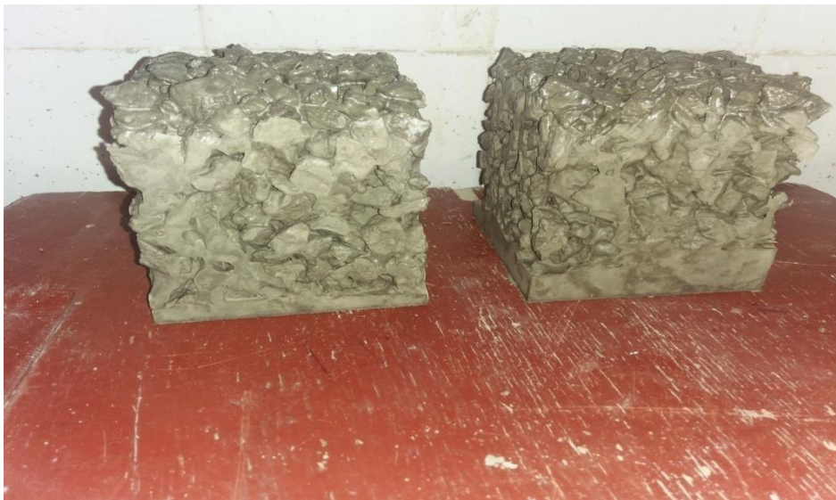
Figure II-9: Béton consolidé avec 5 secondes de temps vibration
