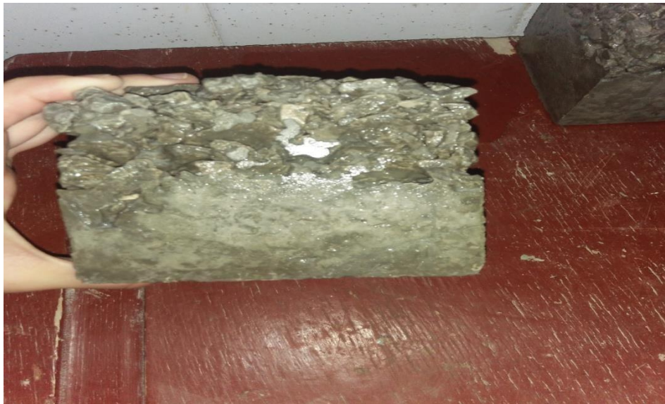
Figure II-10 : Béton consolidé avec 10 secondes de temps vibration
