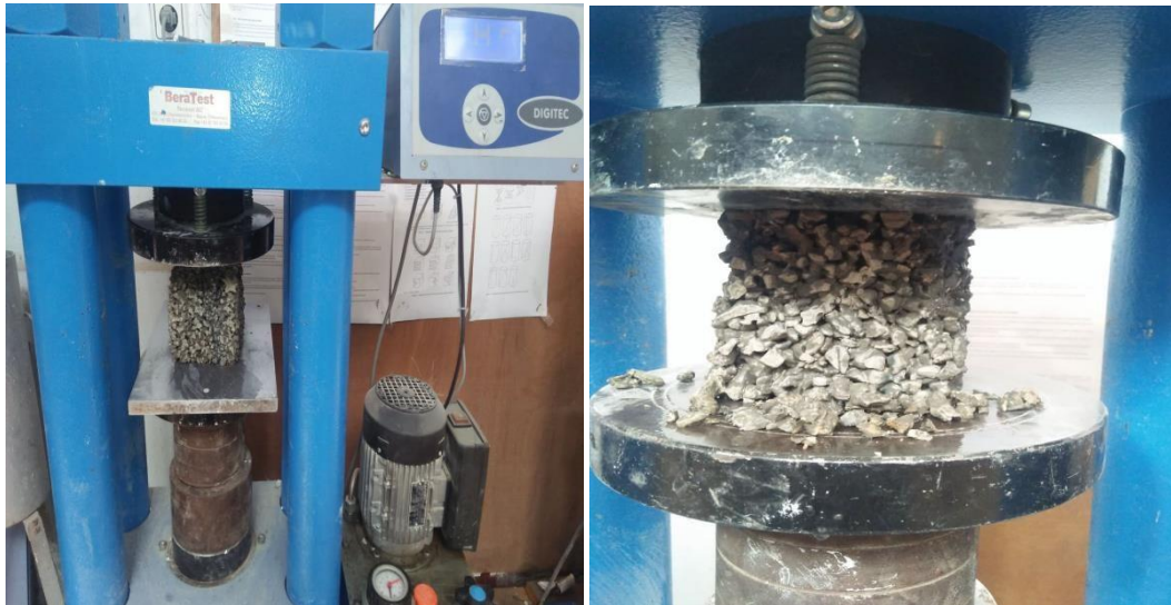
Figure II-18. L'appareil de compression
