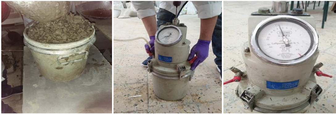
Figure II-16. Les étapes de l'essai de l'air occlus réalisé au laboratoire.
