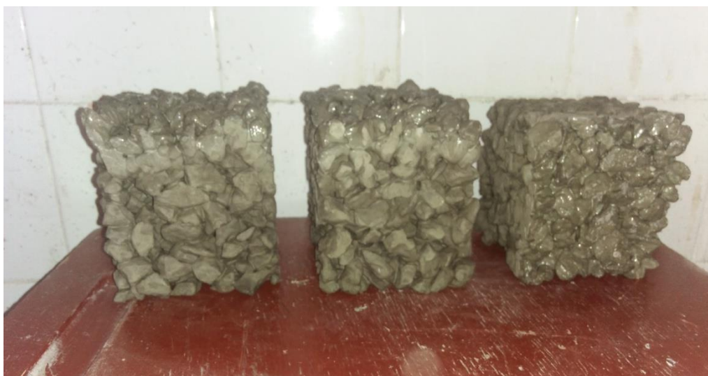
Figure II-12 : Béton consolidé par piquage avec la tige au cône d'Abrams
