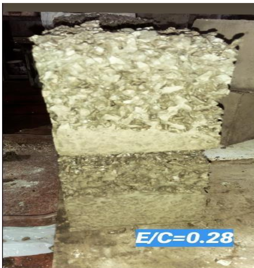
Figure II-7 : Formulation béton drainant réalisée avec un rapport E/C=0,28
