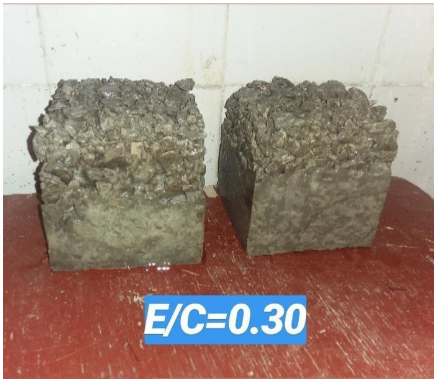
Figure II-6 : Formulation béton drainant réalisée avec un rapport E/C=0,3
