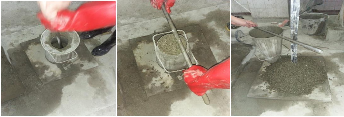
Figure II-13. Les étapes de l'essai du Cône d'Abrams au laboratoire.
