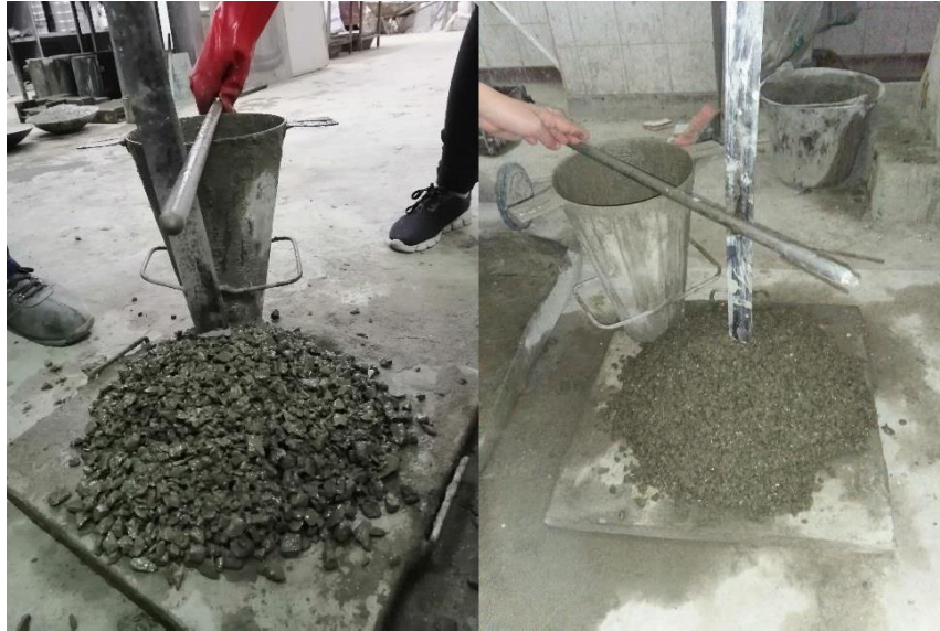
Figure III-2 : Affaissement du béton BRD
