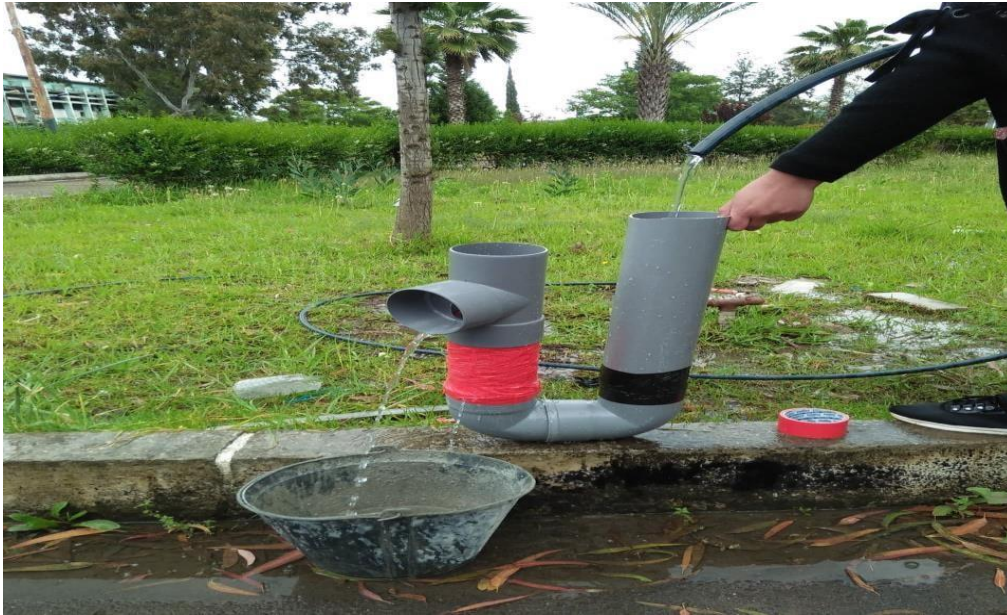
Figure II-20: Essai de perméabilité
