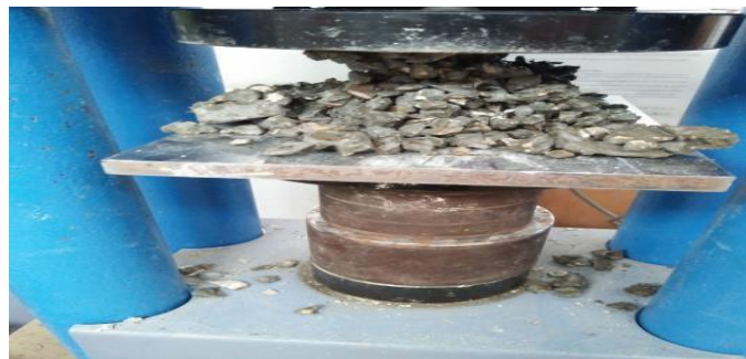
Figure II-19. Ecrasement d'un béton drainant
