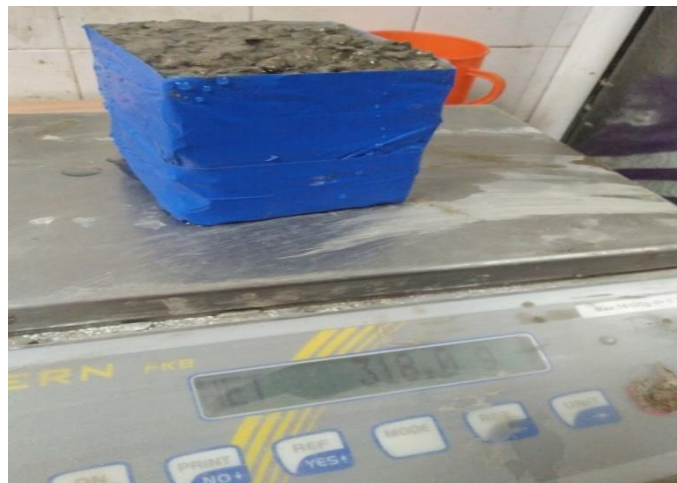
Figure II-17. Essai de volume de vide
