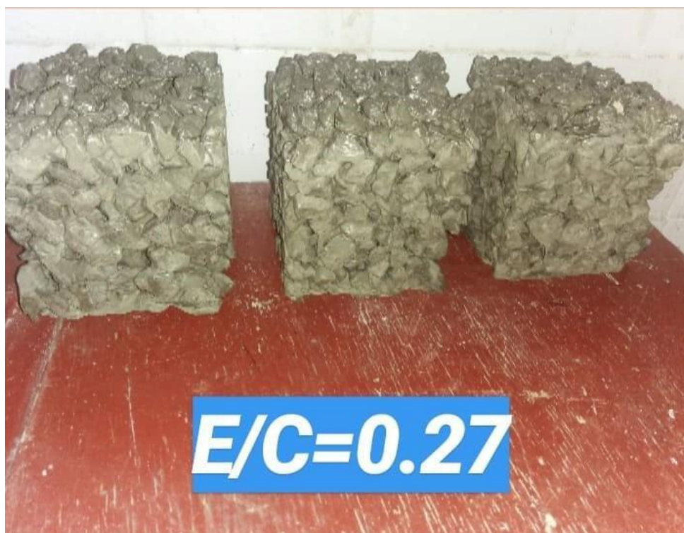
Figure II-8 : Formulation béton drainant réalisée avec un rapport E/C=0,27
