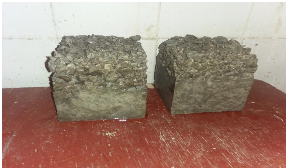
Figure II-11 : Béton consolidé avec 15 secondes de temps vibration
