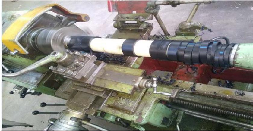
**Figure2-4 :** l'opération de coupe de tube PEHD
