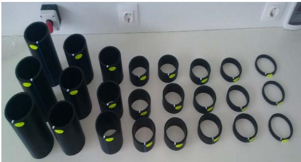
**Figure2-5 :** Eprouvettes sous forme des couronnes (anneau) de diamètre 90mm.
