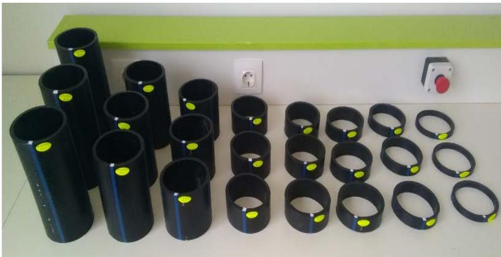
Figure2-6 : Eprouvettes sous forme de couronnes (anneau) de  $\varnothing$  110.
