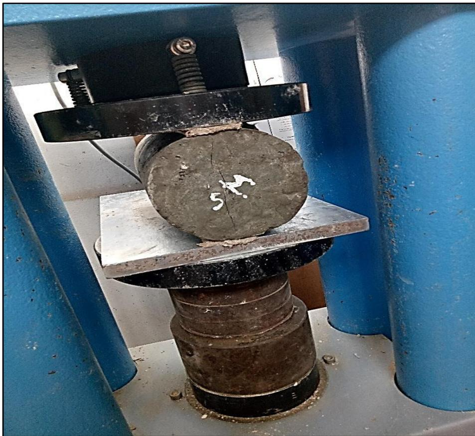
**Figure III.17** : Essai de la résistance à la traction par fendage.
