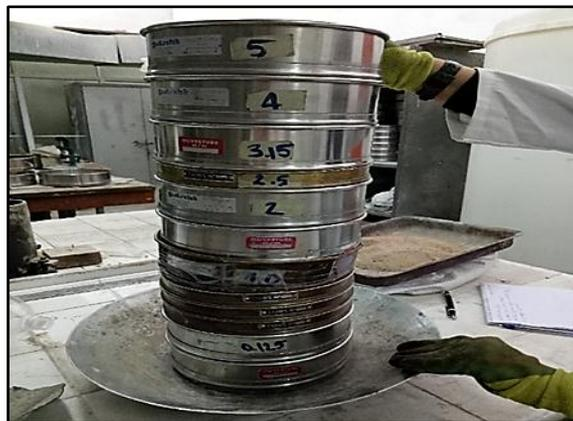
Figure II.7 : Analyse granulométrique du sable.
