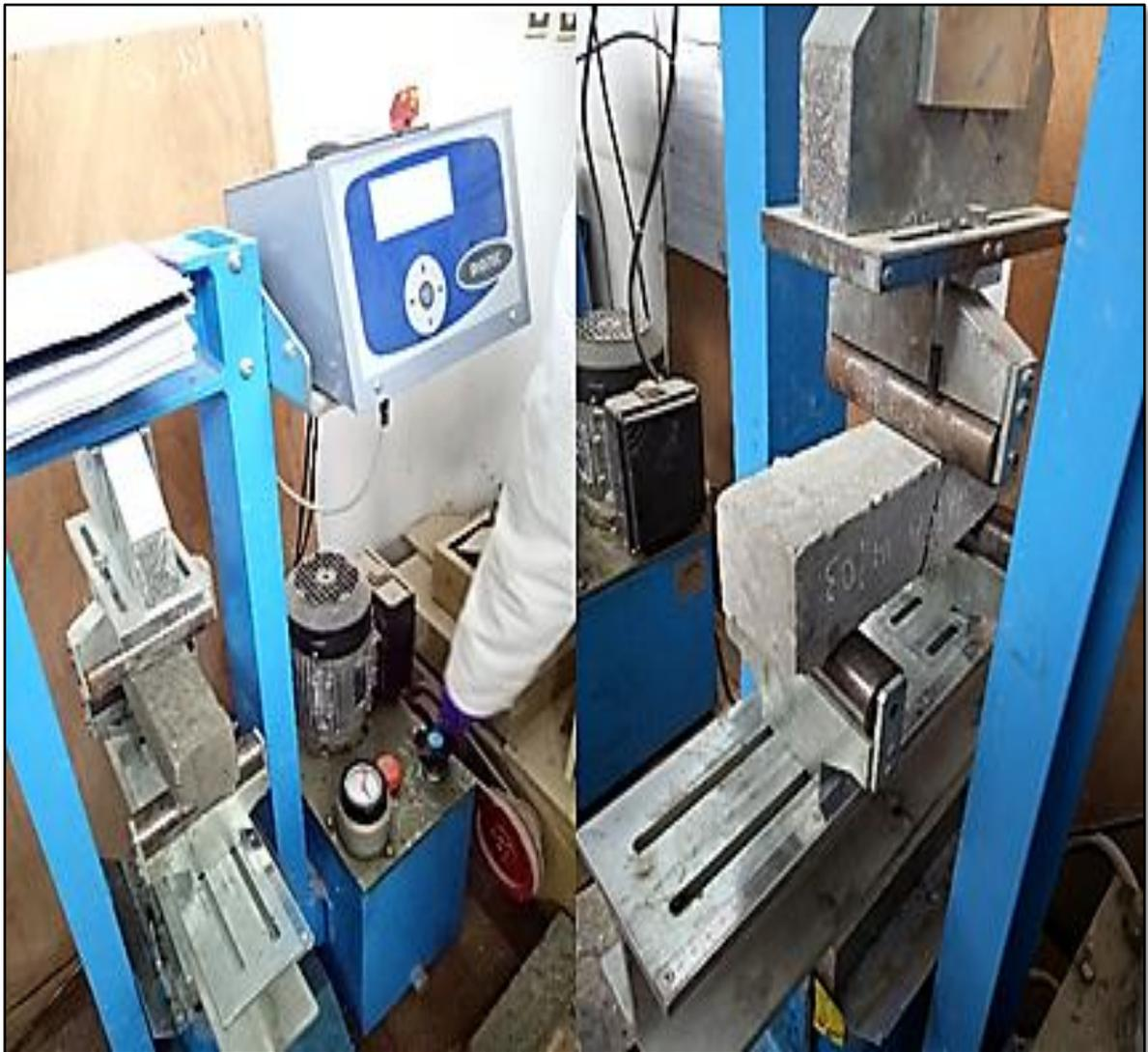
**Figure III.16** : Essai de la résistance à la traction par flexion.
