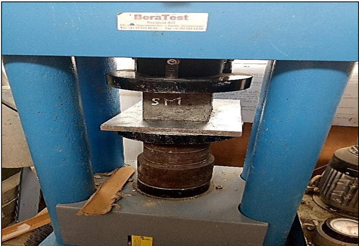
Figures III.15 : Essai de la résistance à la compression.
