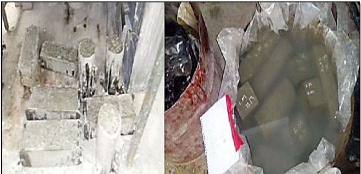
**Figure III.14:** Conservation des éprouvettes.
