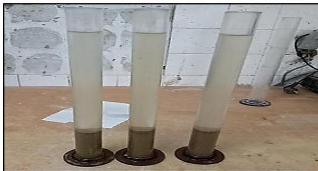
**Figure II.8:** Essai de l'équivalent de sable.
