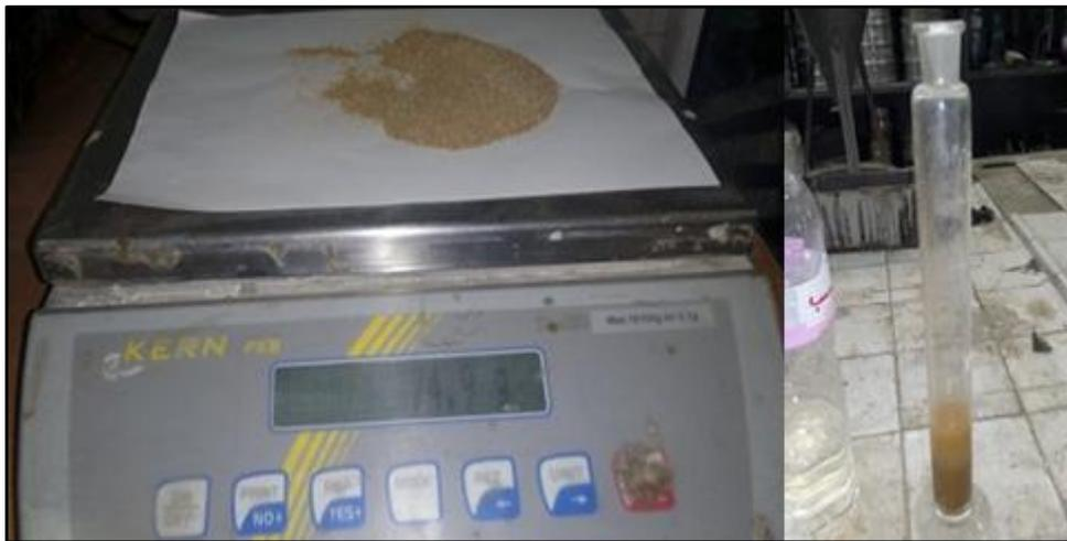
**Figure II.10 :** Essai de la masse volumique absolue.
