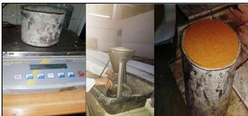
**Figure II.9:** Essai de la masse volumique apparente.
