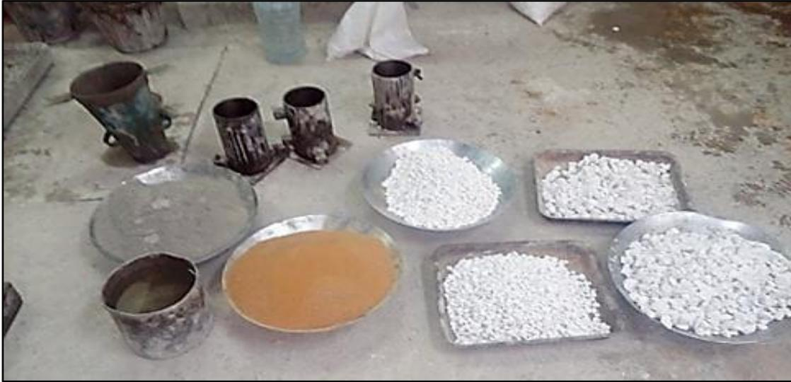
**Figure III.7:** Différents constituants du béton.
