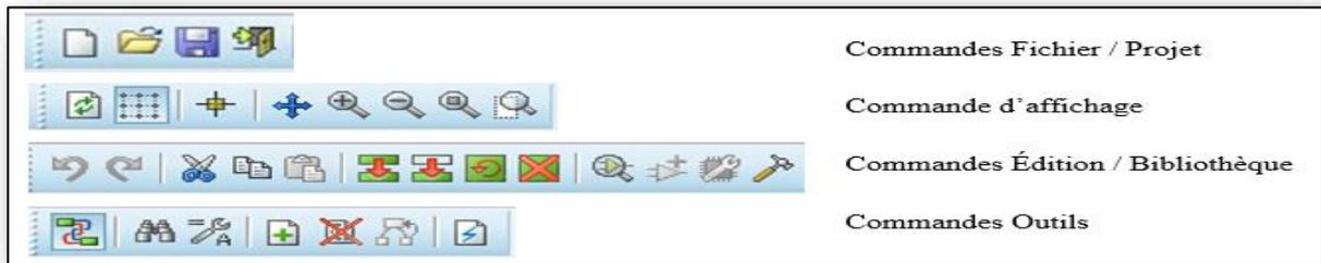
**Figure 8 : Barres d’outils de commande**
