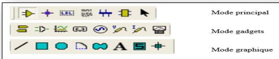
**Figure 9 : Barre d’outils de sélection de mode**
