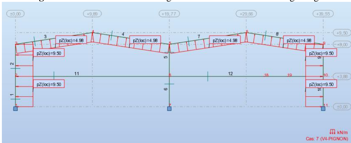
Figure VII-9: Présentation de diagramme du Moment et de charge neige
