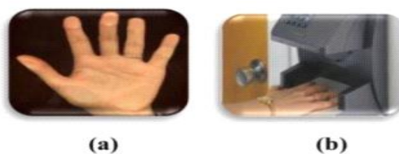
Figure (2) : Image de la géométrie de main ; b) Dispositif de reconnaissance de la géométrie de main.
