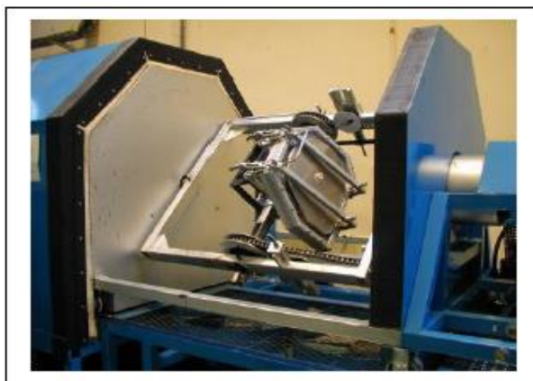
Figure II.10 : Machine de molage par rotation de deux axes perpendéculaire [5.9].
