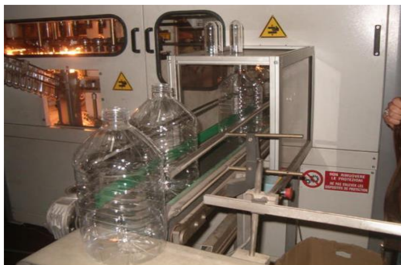
Figure II.13 : Fabrication des bouteilles par machine de moulage [13].
