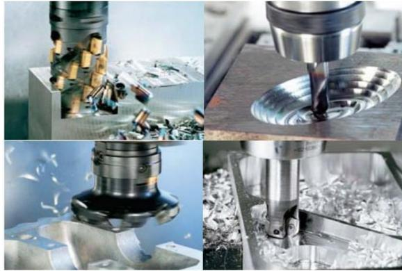
Figure 1.9 : Illustration de différentes opérations en fraisage industrielles. [8]
