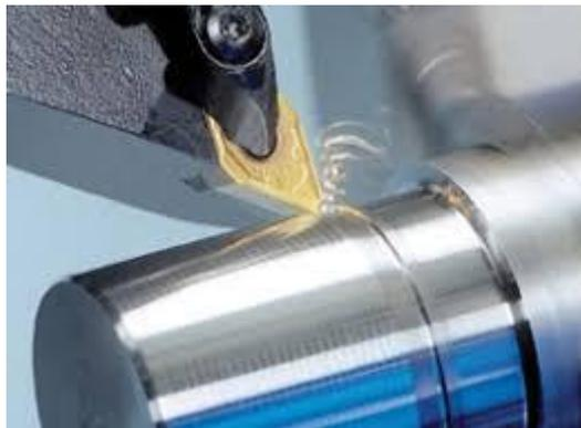
Figure 1.1 : Illustration d'une opération de tournage
