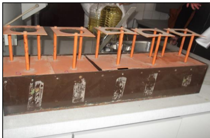
Figure I.14 : Appareil de mesure de l'étanchéité
