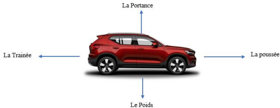
Figure 5 : les forces exercées sur le véhicule
