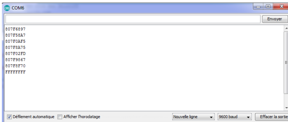
Figure 3-14 : Le code hexadécimal de la commande Infrarouge IR
