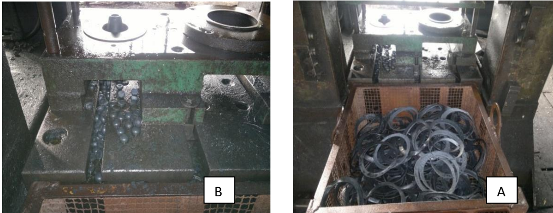
Figure IV.10: Vue arrière de la presse: a) bavures b) Bouts de poinçonnage
