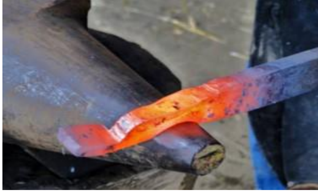
Figure II.1 : exemple d'une pièce forgée
