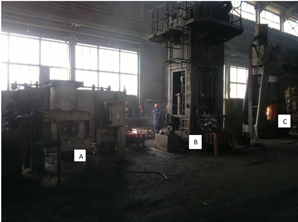
Figure IV.6 : Photographie montrant l'îlot de production de moyeux de roues a) Four ; b) Presse et c) Marteau pilon
