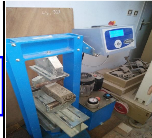
Figure II.6.2. : Essai de traction par flexion
