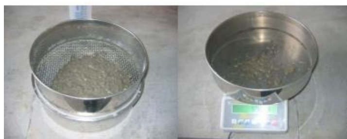
Figure I.6:Essai de stabilité au tamis [11]
