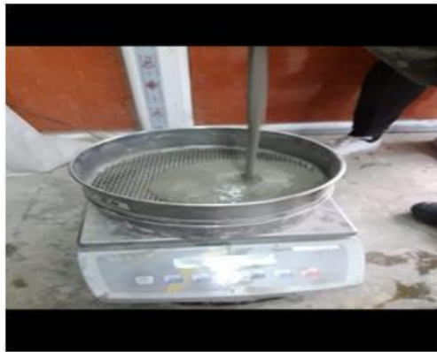
Figure III.2.3 : stabilité au tamis
