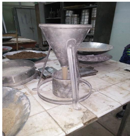
Figure II.12 : Essai de masse volumique apparente
