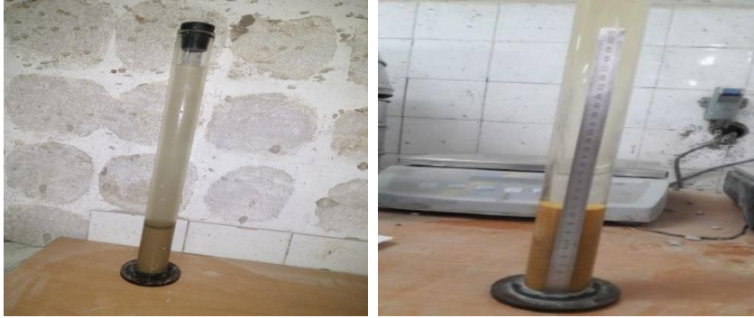
Figure II.11 : Essai d'équivalent de sable
