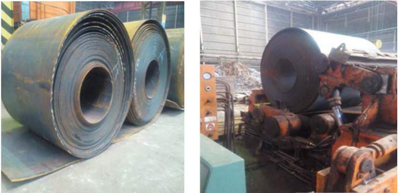
Figure II.1 : Bobine et sa mise en place sur le basculeur
