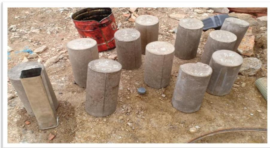
Figure 4.38– Préparation des éprouvettes in situ
