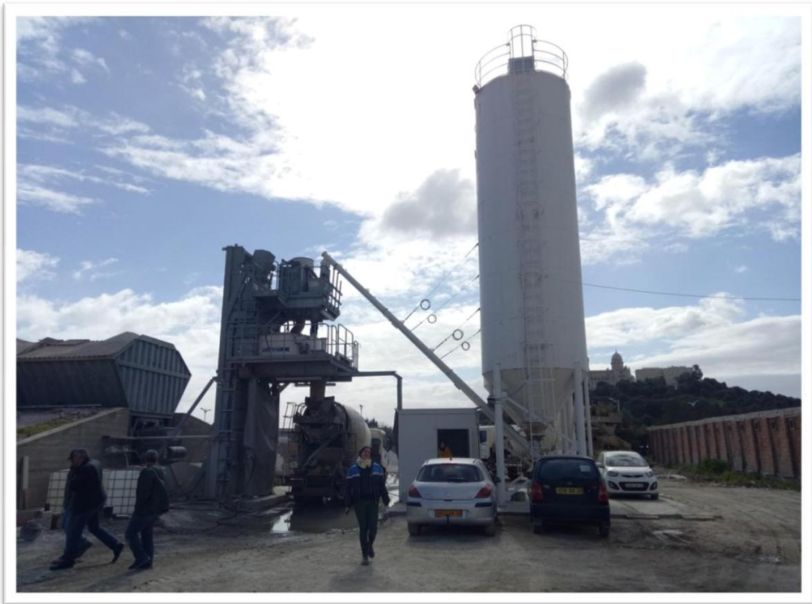
Figure 4.34 – Centrale à béton
