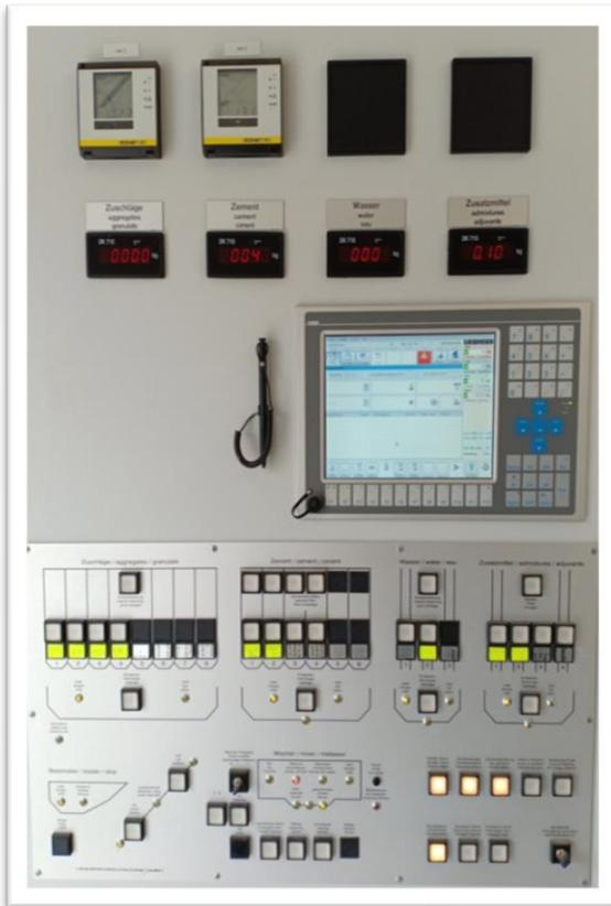
Figure 4.36 – Commandes de la centrale à béton
