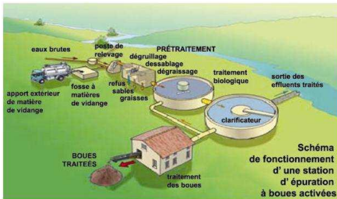
Figure 1.1 – Cycle de l'eau dans une station d'épuration
