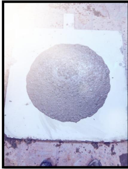
*Figure II.14.* Détermination de l'étalement.
