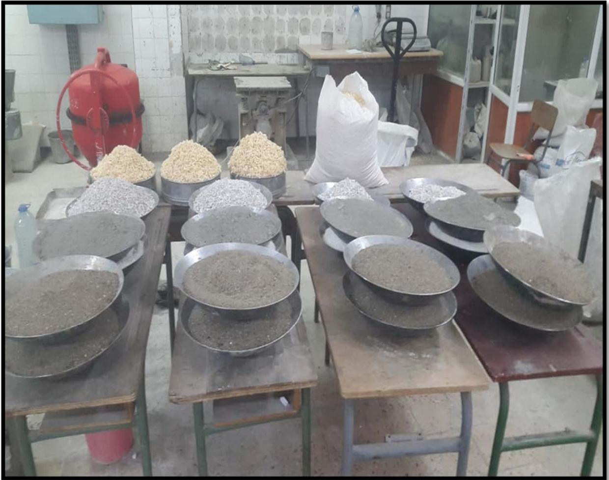
*Figure II.12. Formulation d'un béton autoplaçant avec copeaux de bois.*
