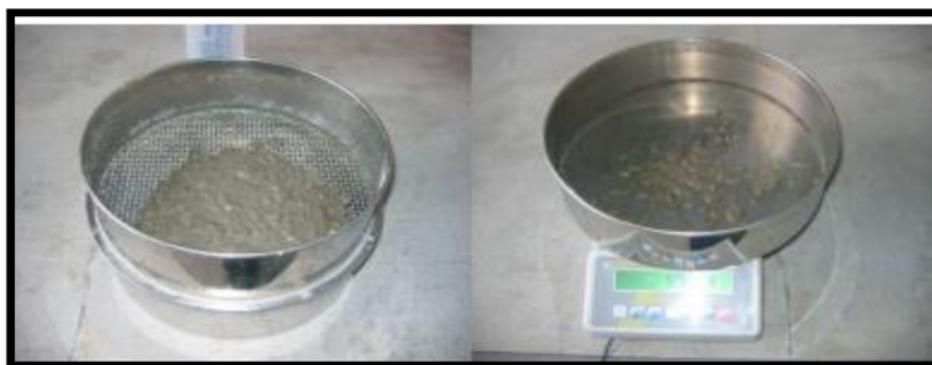
*Figure-II-16 : Essai de stabilité au tamis*
