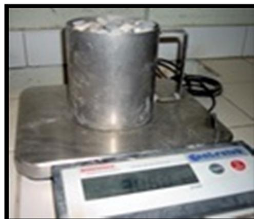
*Figure II.03. Mesure de la masse volumique apparente.*
