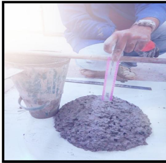
*Figure II.13. Essai d'affaissement au cône d'Abrams.*
