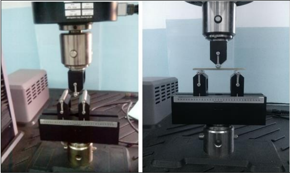
Figure 3.10 : Mise en place de l'éprouvette [23].
