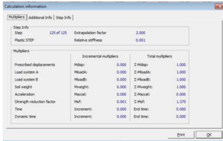
Figure 4.136. Phase 3 : Obtention de coefficient de sécurité FS=1.375
