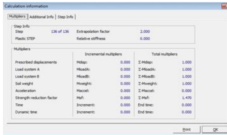
Figure 4.99. Phase 3 : Obtention de coefficient de sécurité FS=1.470
