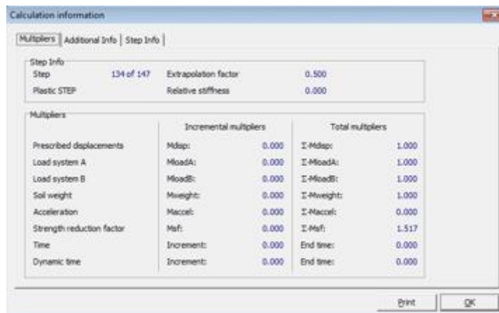
Figure 4.87. Phase 3 : Obtention de coefficient de sécurité FS=1.517
