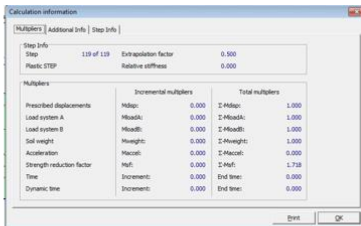
Figure 4.155. Phase 4 : Obtention de coefficient de sécurité FS=1.718
