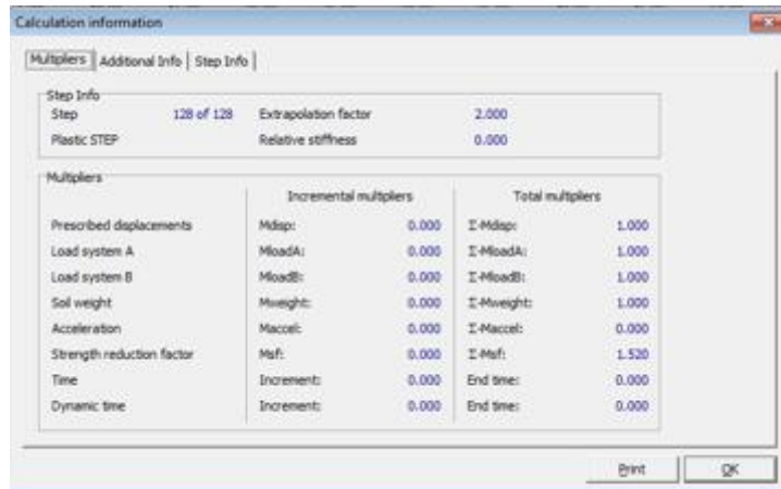
Figure 4.117. Phase 3 : Obtention de coefficient de sécurité FS=1.520
