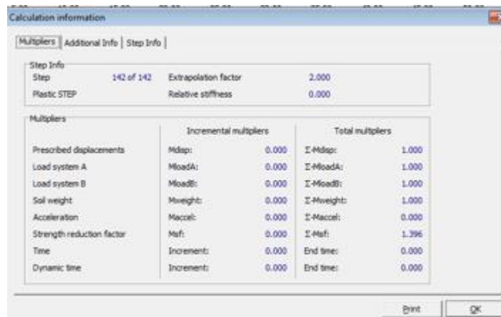
Figure 4.68. Phase 3 : Obtention de coefficient de sécurité FS=1.396
