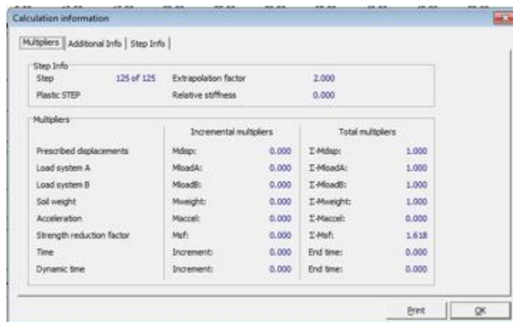
Figure 4.148. Phase 3 : Obtention de coefficient de sécurité FS = 1.618
