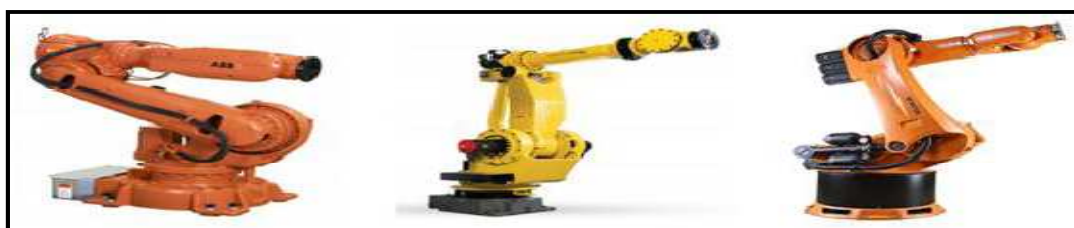
Figure I.8 : Robots manipulateurs ABB 6620 à gauche, FANUC i900A au milieu, KUKA KR500-3MT à droit.
