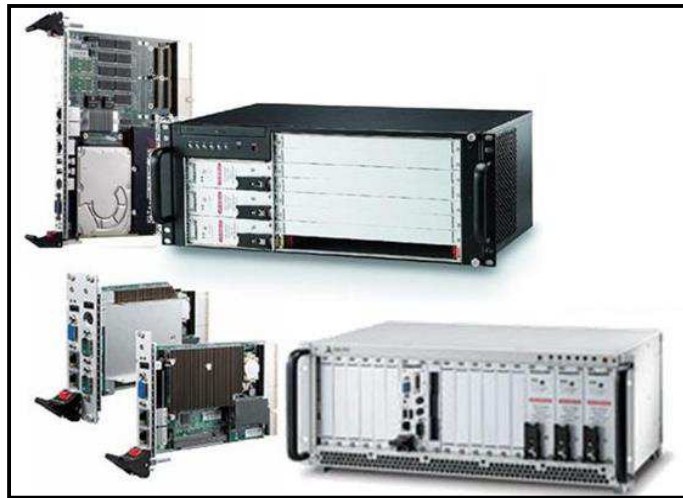
Figure I.16 : Exemples de systèmes rackables
