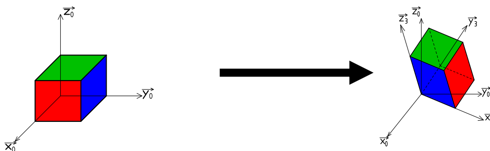
Figure I.9 : orientation d'un solide dans l'espace
