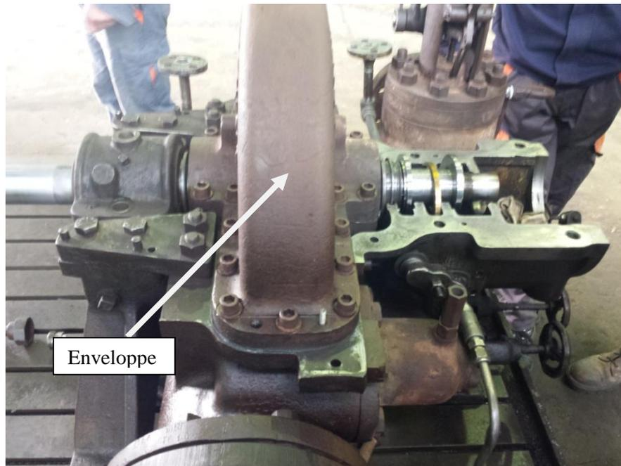
**Figure III.4. Enveloppe de la turbine.**
