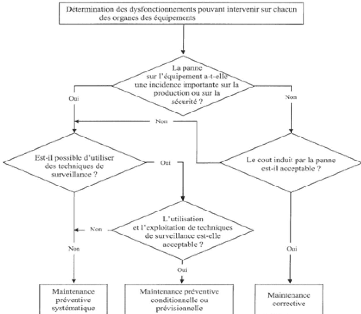
Figure .IV.4.Arbre décisionnel de définition des actions de maintenance
