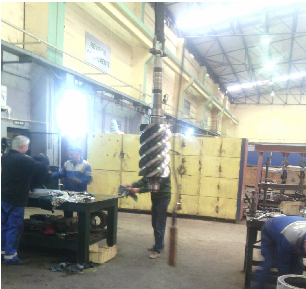
Figure.V.2 Dépose du compresseur (rotor)
