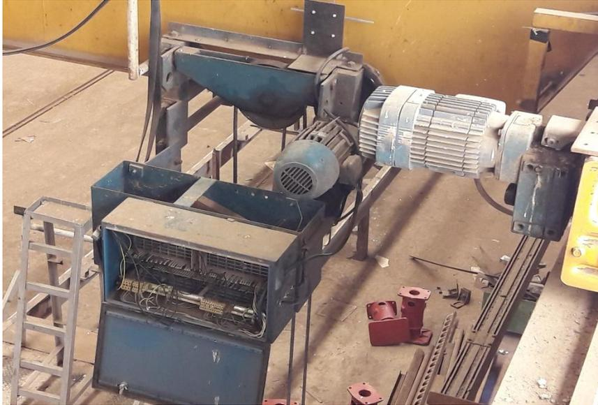
Figure 1.19: Moteur de levage..... [40]
