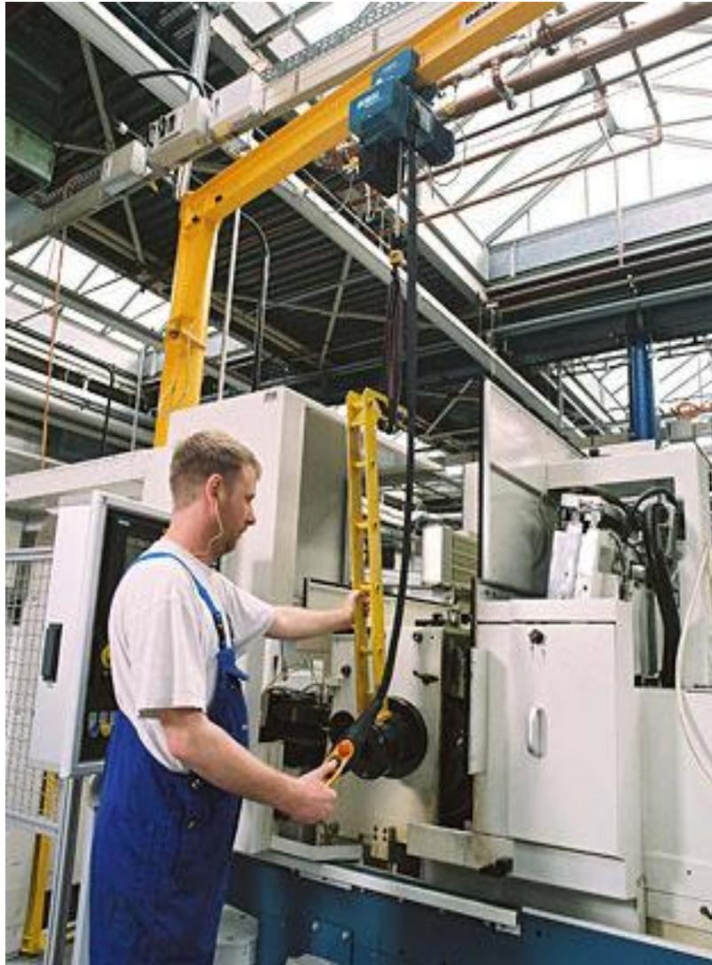
**Figure 1.2 :** Commande fixe au chariot..... [7]
