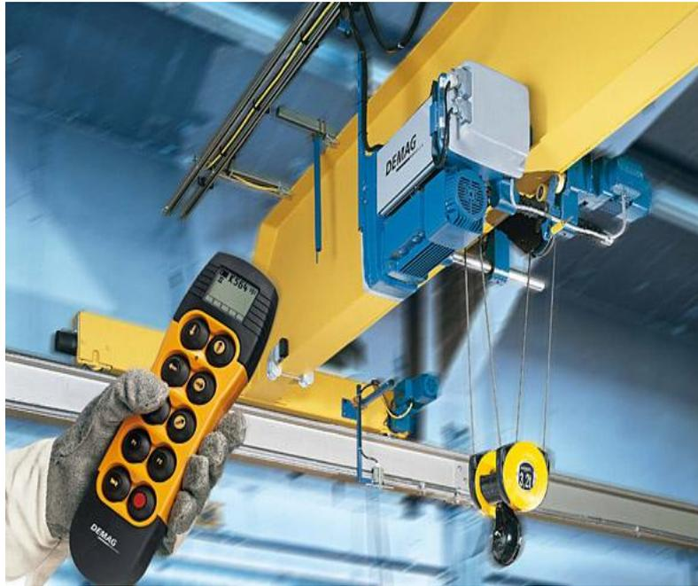
**Figure 1.4** : Commande radio à distance..... [9]
