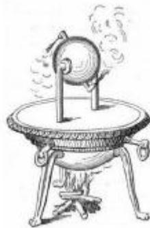
*Figure III.3 : L’éolypile décrite par Héron.*
