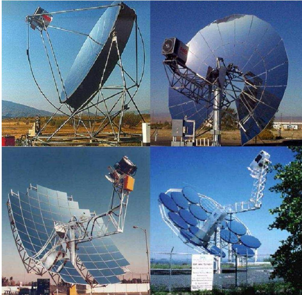
Figure III.18 : Les différents types de concentrateurs paraboliques.
