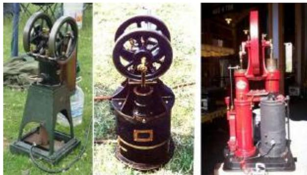
*Figure III.8 : quelques moteurs de Stirling anciens.*
