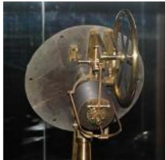
*Figure III.11 : Photographie du premier dish-Stirling réalisé par Ericsson.*
