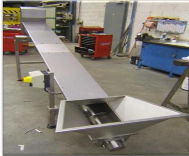
**Figure 13: Convoyeur à vis sans fin**
