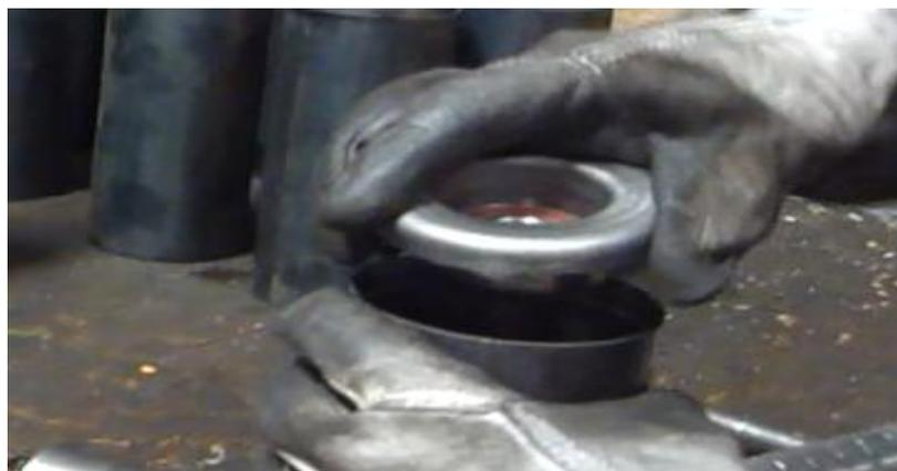
**Figure 37: assemblage boitier de roulement et roulement**
