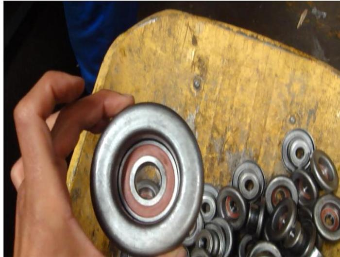
**Figure 32: assemblage boitier de roulement et roulement**
