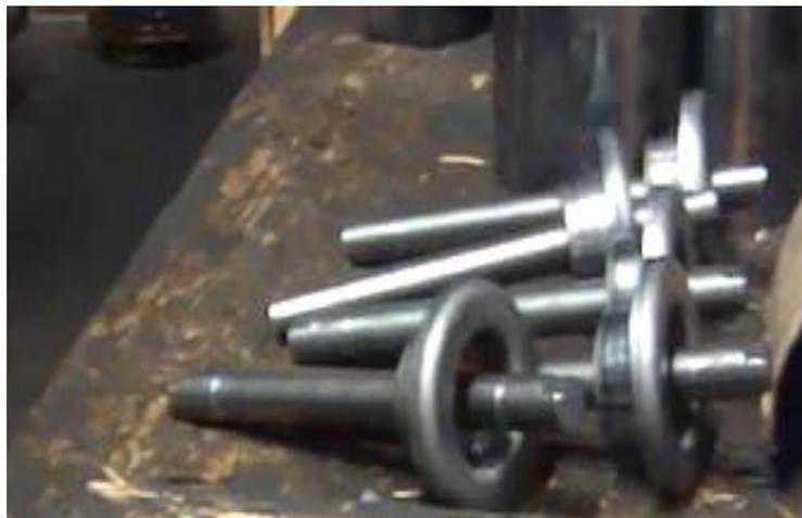
**Figure 34: assemblage du boitier de roulement et roulement sur l'axe**
