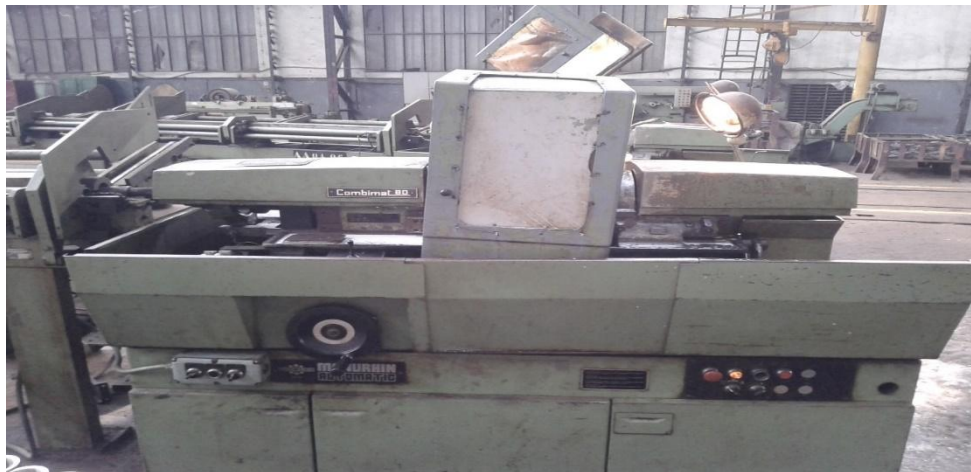
Figure I.16 : Tour C80 automatique ciblée dans l'atelier d'usinage.
