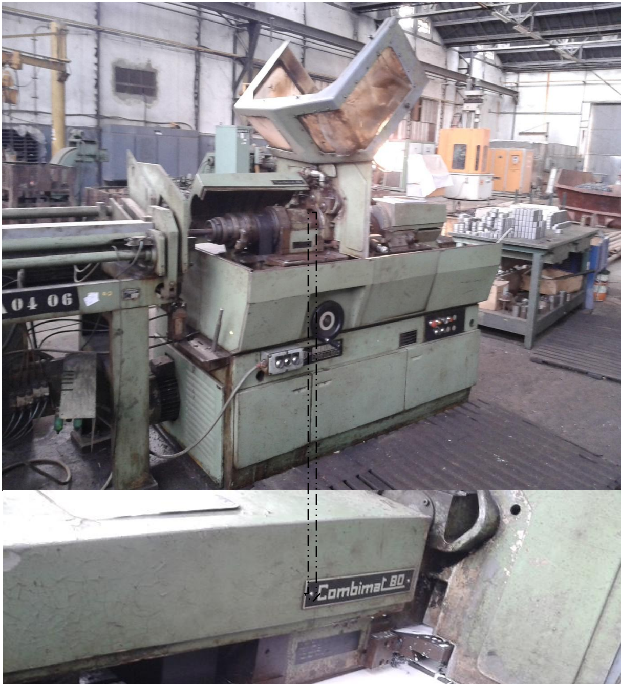
Figure II.1 : Photo du tour automatique COMBIMAT 80.
