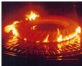
Figure IV.4 : Pignon au cours du traitement thermique.
