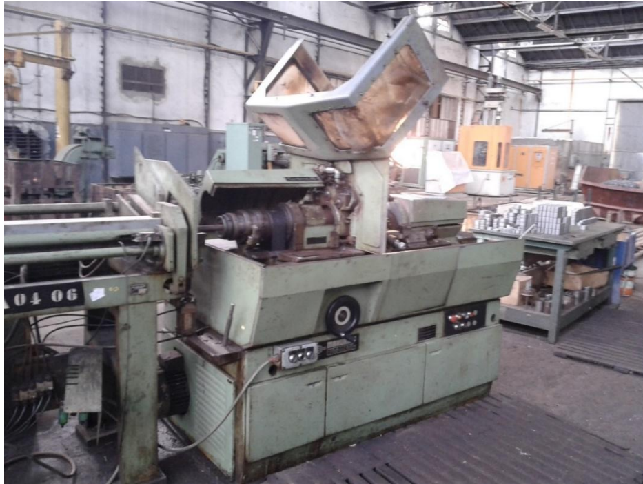
Figure II.29 : La relation directe entre l'embarreur AES et le tour C80.
