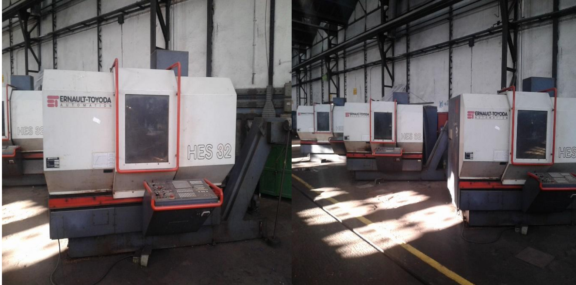
Figure I.17 : Tours HES 32 à commande numérique dans l'atelier d'usinage.
