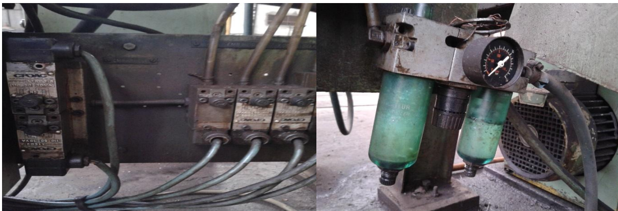
Figure II.34 : Ensemble de transmission de mouvement (distributeurs + pompes).
