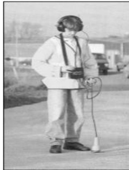
Figure I- 2: Parmi les appareils d'auscultation typiques se trouvent les tiges d'écoute (gauche) et les microphones au sol (droite).
