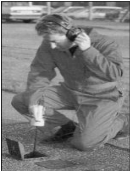
Figure I- 2: Parmi les appareils d'auscultation typiques se trouvent les tiges d'écoute (gauche) et les microphones au sol (droite).
