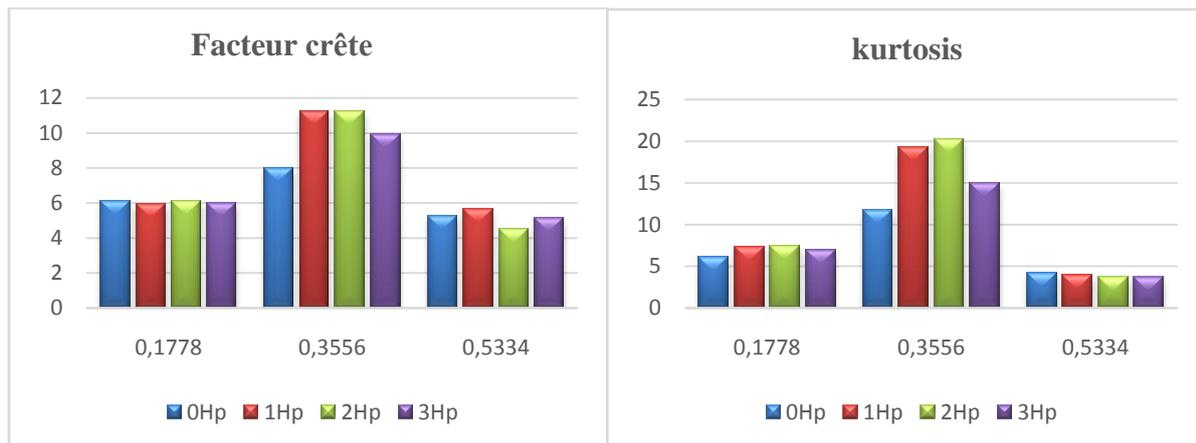
**Figure 3.6.** Evolution des indicateurs scalaires en fonction de diamètre de défaut sur la bague intérieure.
