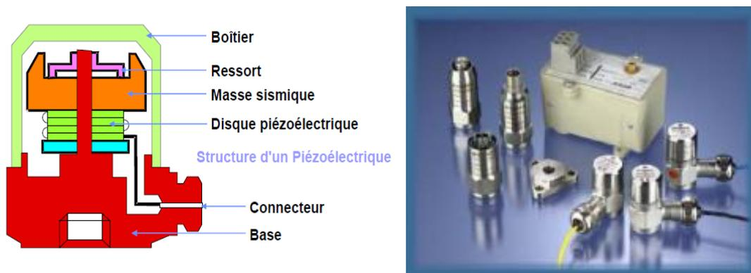
**Figure 2.6.** Accéléromètre (capteur piézo-électrique).
