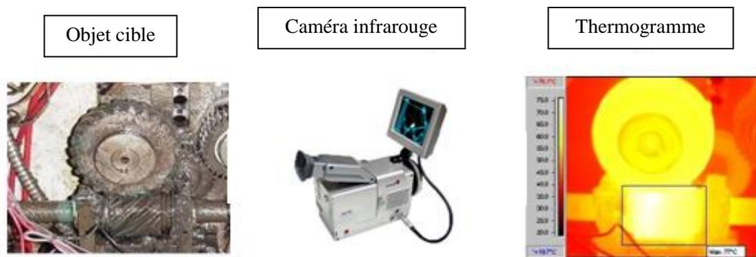
**Figure 1.4.** Exemple de la thermographie infrarouge.
