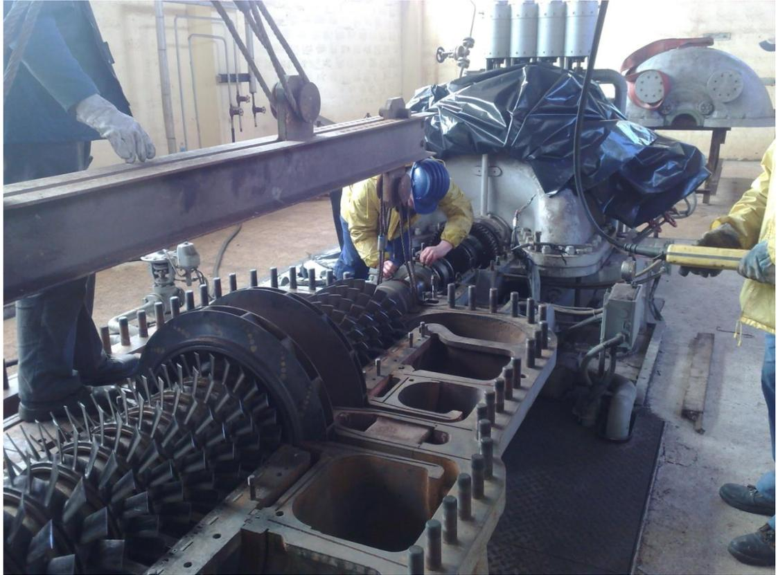
*Fig. II .5 : Photographie compresseur axial d'air*
