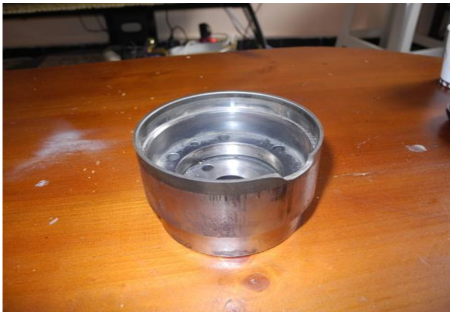
Figure 13 : cassure de la cloche de coupe
