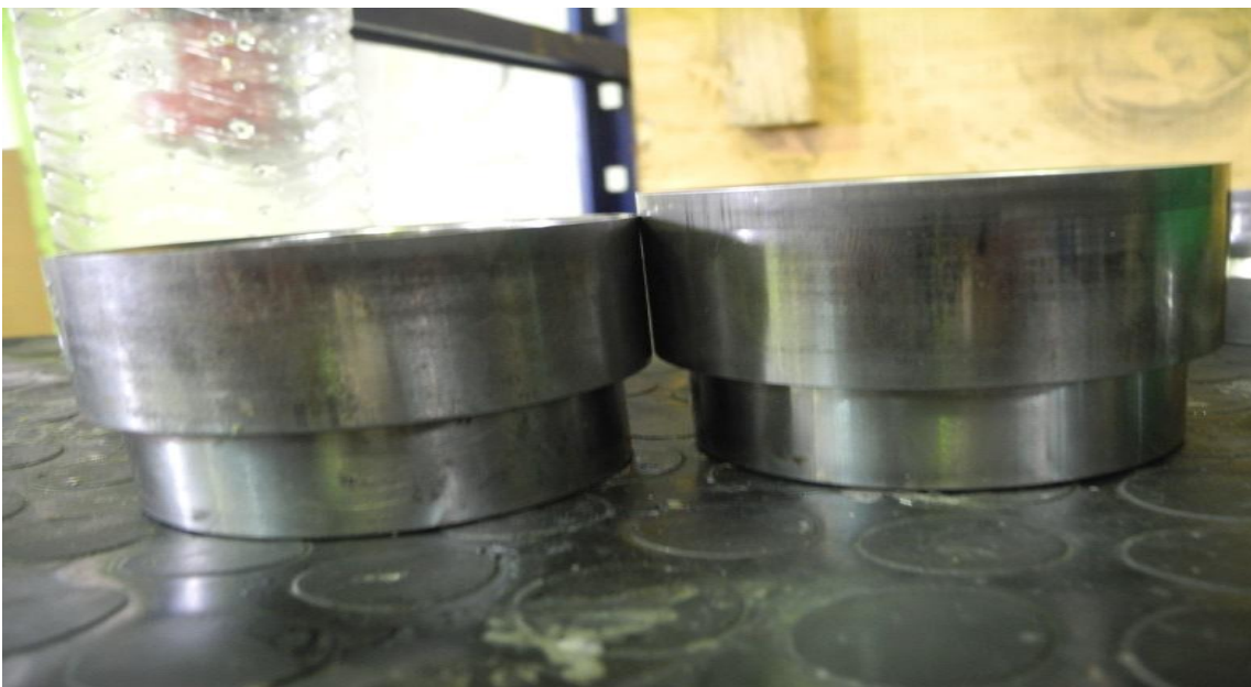
Figure 12 : l'usure de la cloche de coupe (poinçon)
