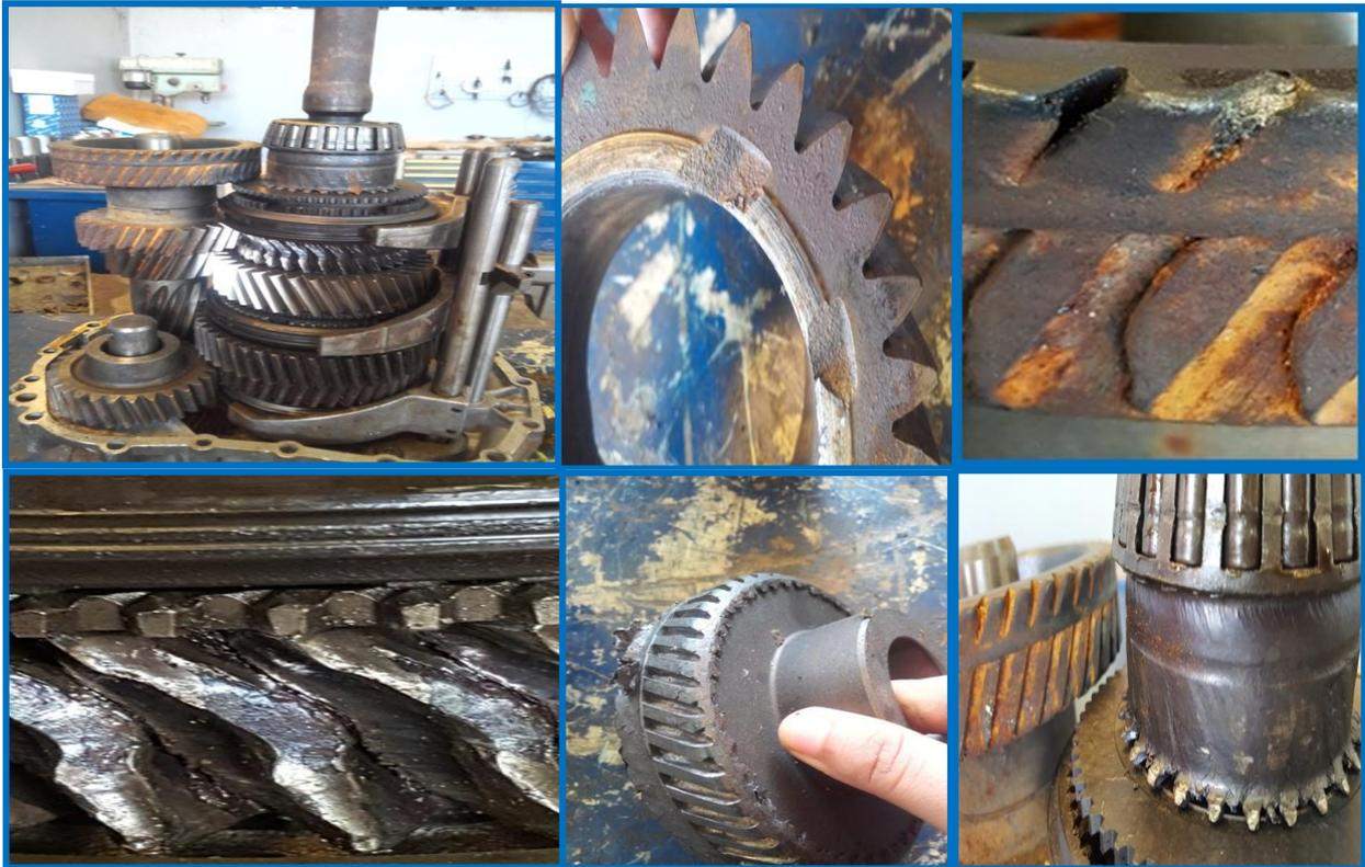
*Fig.III.10.* Différents défaillances sur les dents.
