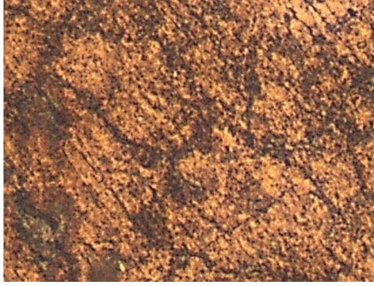
Figure IV .8. Acier C18 trempé dans l'eau grossissement x50
