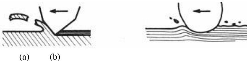
Figure I.19 : Mécanisme de l'abrasion ; (a) par coupe ;(b) par déformation plastique [5].
