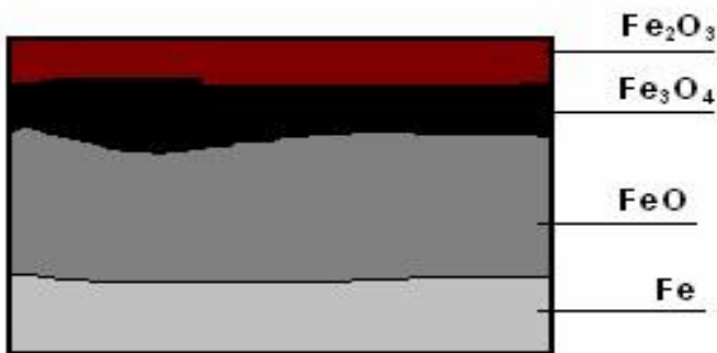
Figure I.21 : Formation des couches d'oxydes superposées sur la surface du fer à 625 °C après 24 h.
