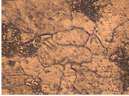
Figure IV .4. Acier C18 à l'état recuit. Grossissement x50
