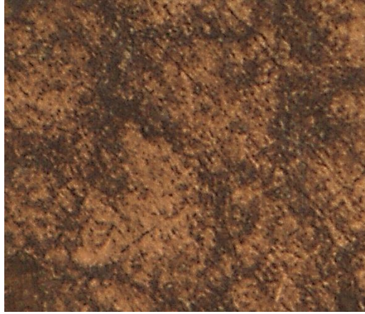
Figure IV .9. Acier C18 trempé dans l'eau grossissement x100
